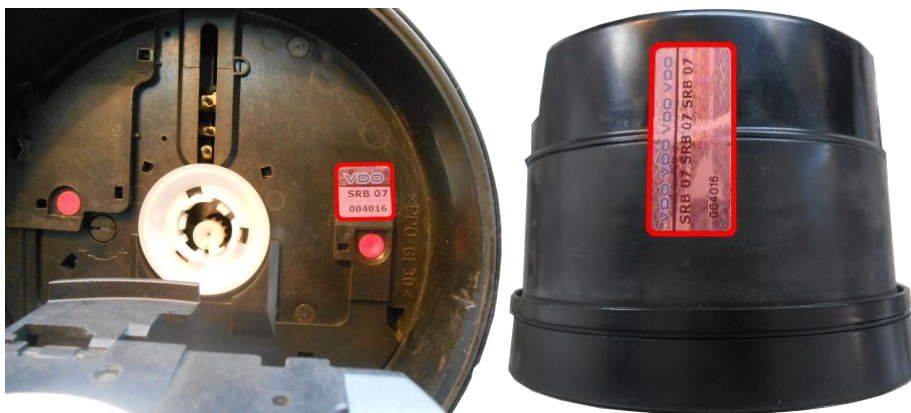
Слика 24. Нумерисане заштите на јединици у возилу КТСО 1318 [12]
