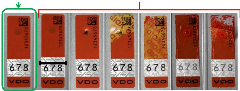
Слика 85. Исправна и оштећене сервисне холограмске заштите кућишта DTCO 1381 [12]
