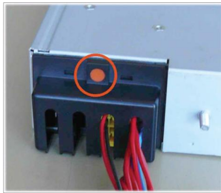
Слика 93. EFAS 4.8 позиција пломби са жигом за преглед тахографа на доњој страни кућишта (лево) и на поклопцу конектора (десно) [27]
