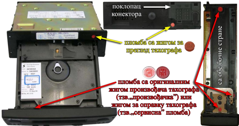
Слика 64. Изглед и позиција пломби на јединици у возилу TVI 2400 [22]
