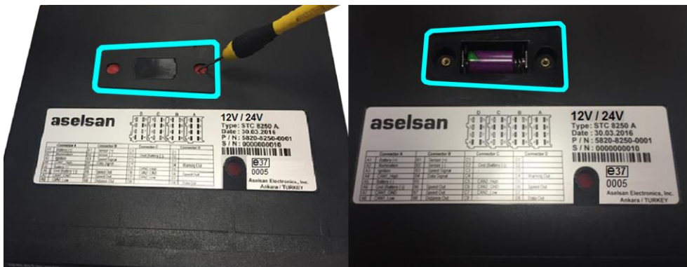
Слика 127. Позиција батерије на горњем делу кућишта STC 8250 и поступак замене [30]
