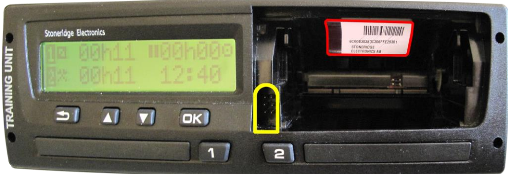
Слика 114. Прикључак за преузимање података, преглед и подешавање (програмирање) SE5000 и заштитна налепница у простору штампача [22]
