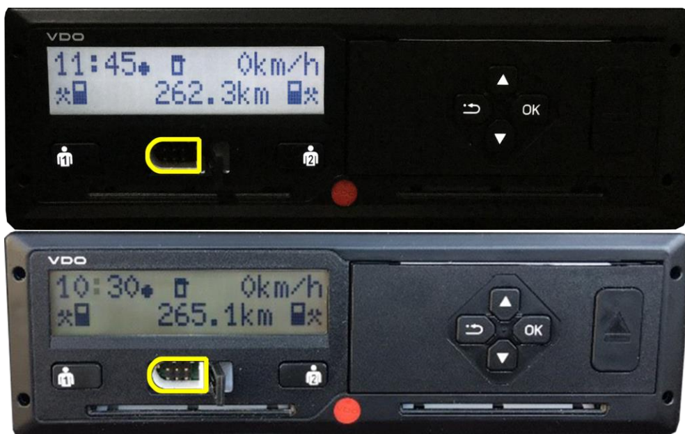
Слика 80. Положај и изглед прикључка за преузимање података, преглед и подешавање треће верзије DTСO 1381 серије 2.2x [12]
