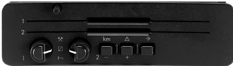
Слика 41. Изглед предње маске FTCO 1319 на преклопницима и читачима (слотовима) тахографских листића за возача 1 и 2 и функцијским тастерима [14]
