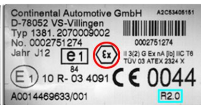
Слика 78. Положај Ex ознаке на маски јединице у возилу (ДТ намењеног за уградњу у возила за превоз опасних материја по АDR) и натписној плочици DTCO 1381 [12]
