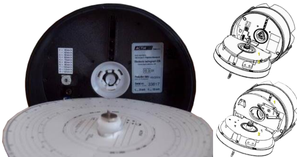
Слика 49. Постављање тахографских листића возача 1 и 2 у јединицу у возилу Астиа 028 [21]
