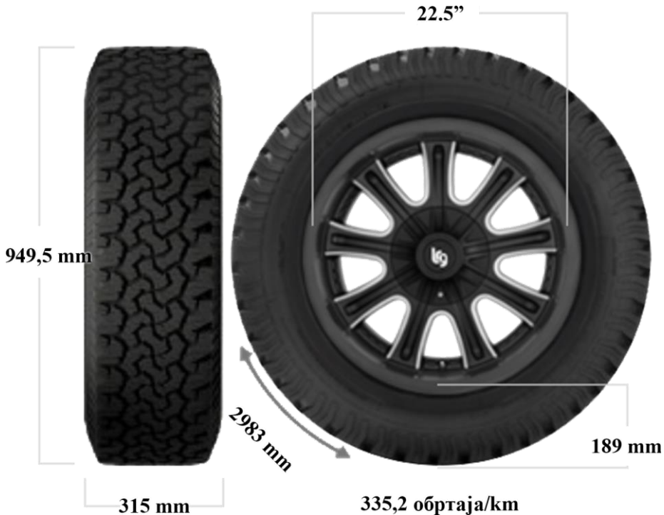
Слика 153. Конструкционе и израчунате величине гуме димензије 315/60 R 22.5
