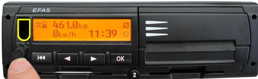
Слика 97. Прикључак за преузимање података, преглед и подешавање (програмирање) ДТ EFAS [25]
