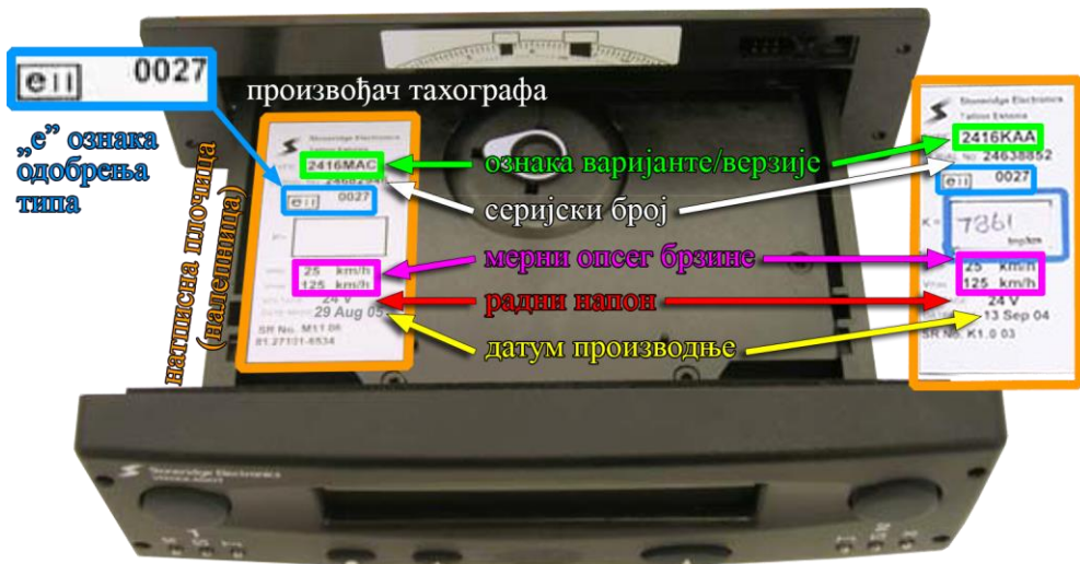
Слика 63. Натписне плочице TVI 2400 за више верзија уређаја, са одобрењем типа e11-27 и националном ознаком одобрења B-03-027 [22]
