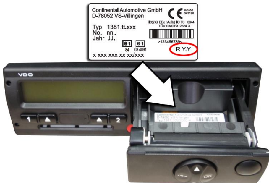
Слика 75. Изглед и локација натписне плочице на DTСO 1381 до серије 2.2 [12]
