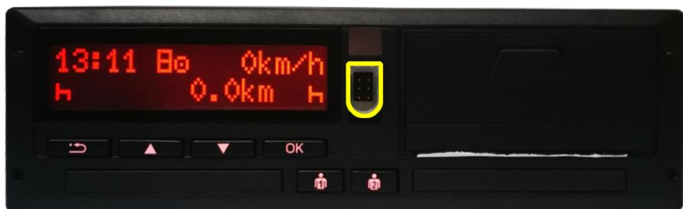
Слика 81. Положај и изглед прикључка за преузимање података, преглед и подешавање тахографа треће генерације DTСO 1381 верзије 3.0 [12]
