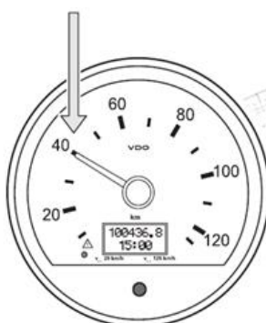
Слика 177. Преглед брзиномера и записа брзине помоћу уређаја СТС II [14]
