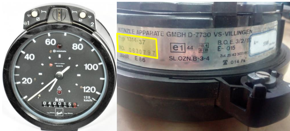
Слика 66. Изглед и натписна плочица (налепница) 1314 одобрења типа e1-44 [12]
