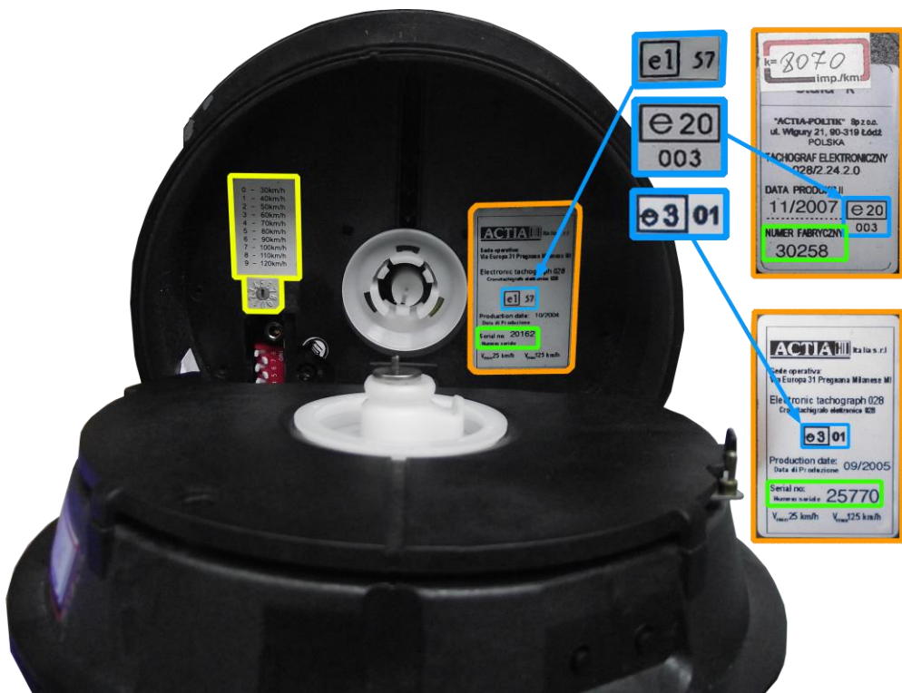
Слика 48. Положај и изглед натписне плочице (налепнице) Astia 028 са одобрењем типа e3-01, e20-003 и e1-57 са националном ознаком одобрења В-03-026
