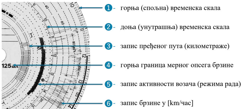
Слика 5. Елементи и записи на предњој страни тахографског листића
