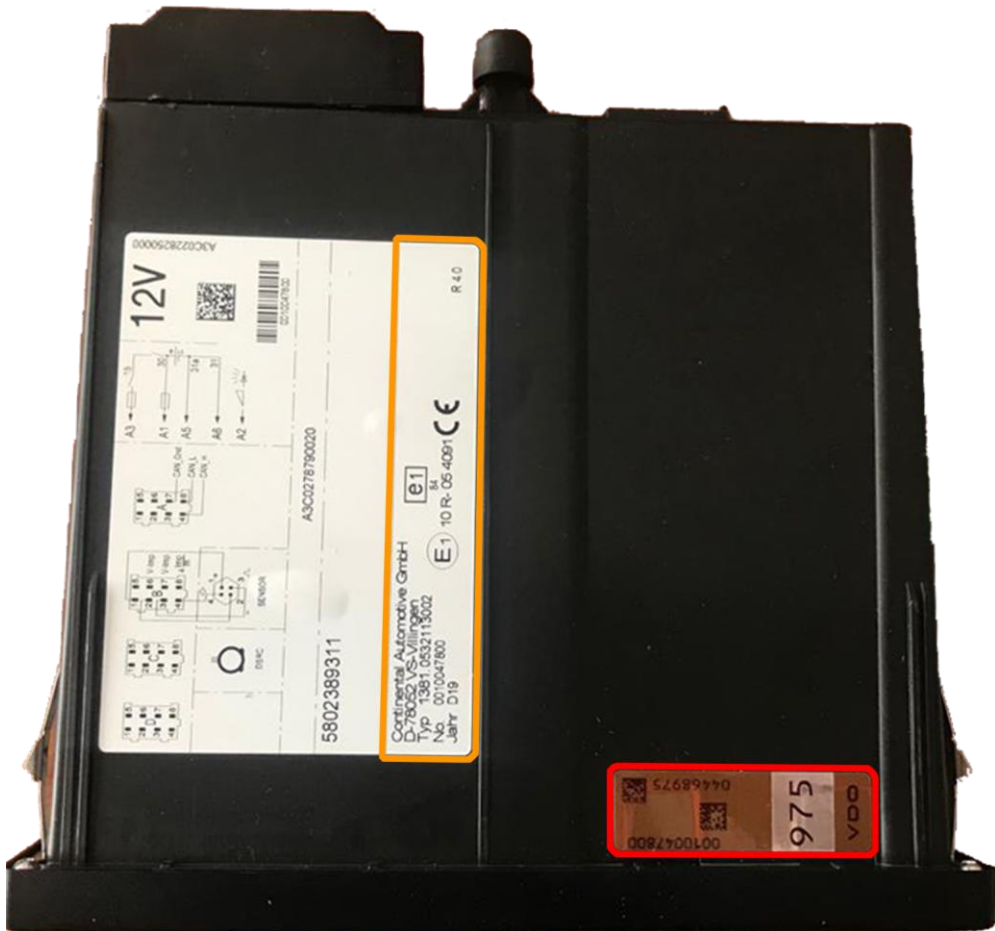
Слика 133. Приказ ознаке одобрења типа и техничких карактеристика, као и заштите кућишта јединице у возилу DTCSO 1381 верзија 4.0 [31]
