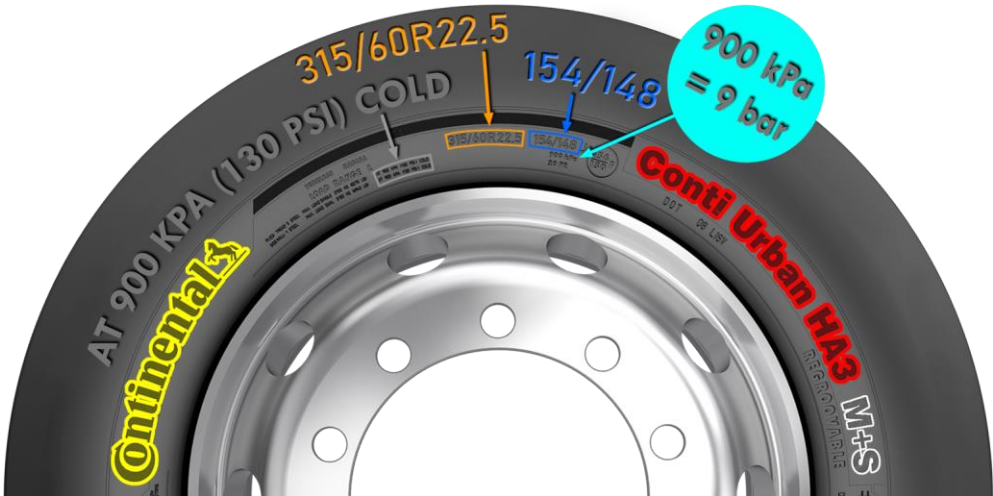
Слика 152. Марка, тип, декларисани притисак и други значајни подаци на гумама
