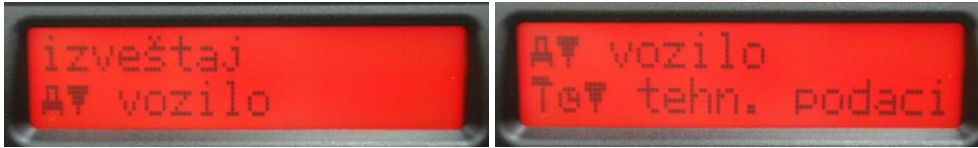
Слика 198. Улазак у мени штампања исписа и проналажење исписа техничких података (Тест) [12]
