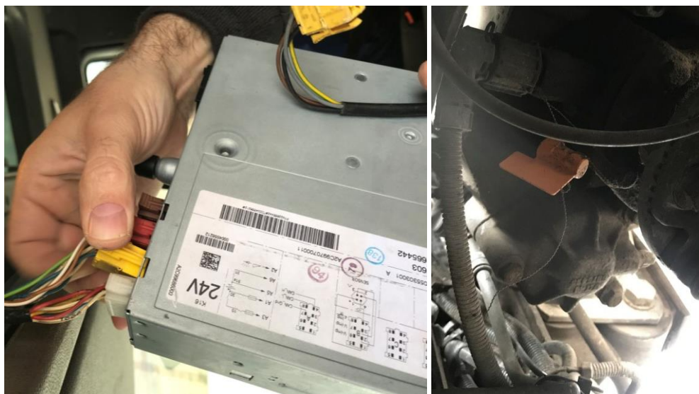
Слика 204. Искључивање каблова (инсталације) који повезују јединицу у возилу ДТ - лево и сензор кретања - десно
