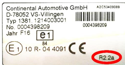
Слика 77. Различите натписне плочице по верзијама прве генерације ДТ по серијама DTCO 1381 [12]
