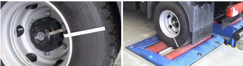
Слика 161. Одређивање ефективног обима погонског точка и коефицијента возила на обртним ваљцима
