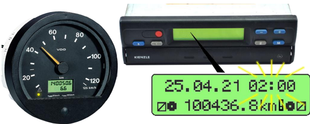
Слика 176. Грешка на дисплеју МТСО 1324 код разлике системског и времена записа [33]
