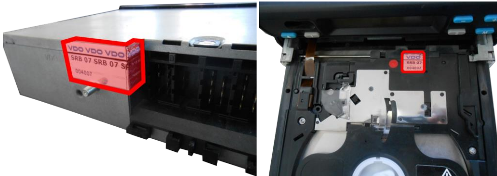
Слика 58. Нумерисане заштите на јединици у возилу МТСО 1324 [12]
