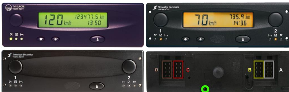
Слика 59. Спољашњи изглед јединица у возилу TVI 2400 спреда (за 1 возача, за 2 возача са и без дисплеја) и отпозади [22]
