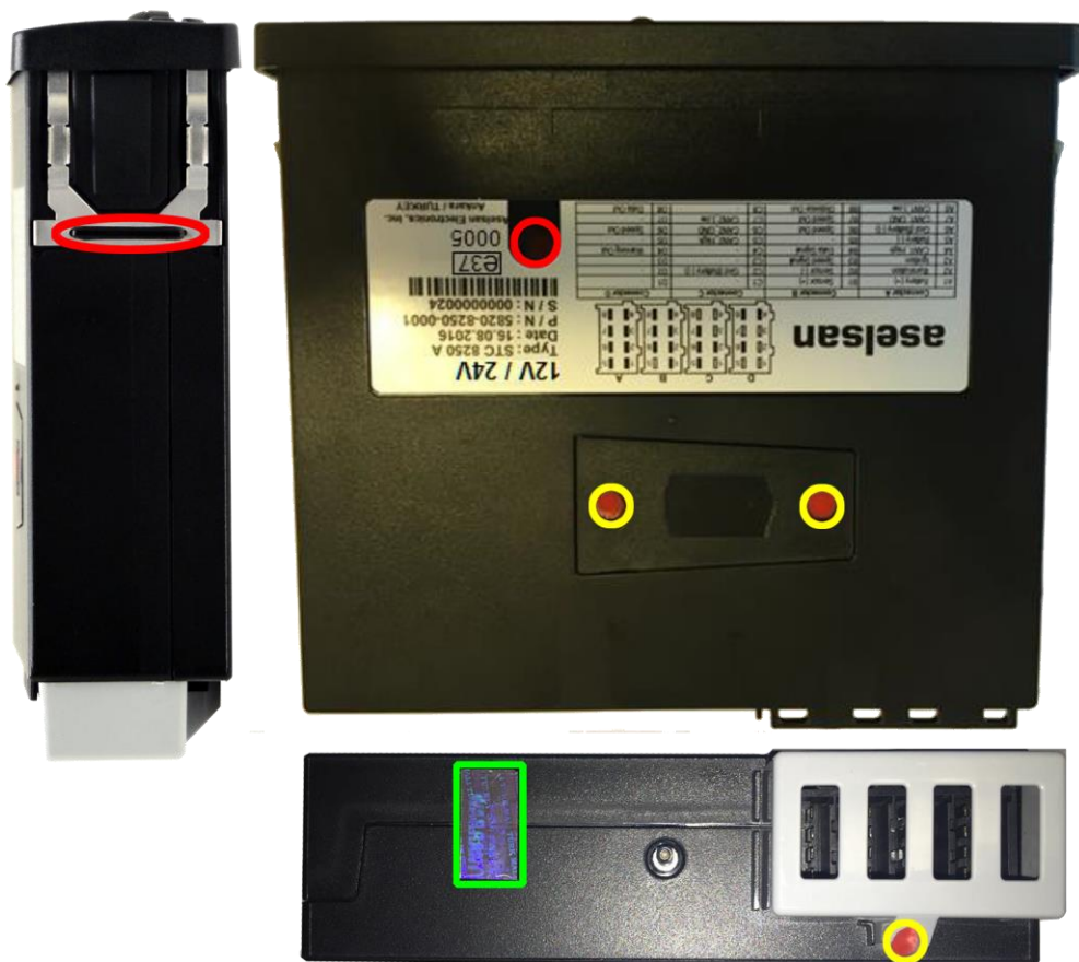
Слика 128. Пломбе и заштите кућишта јединице у возилу STC 8250 [30]
