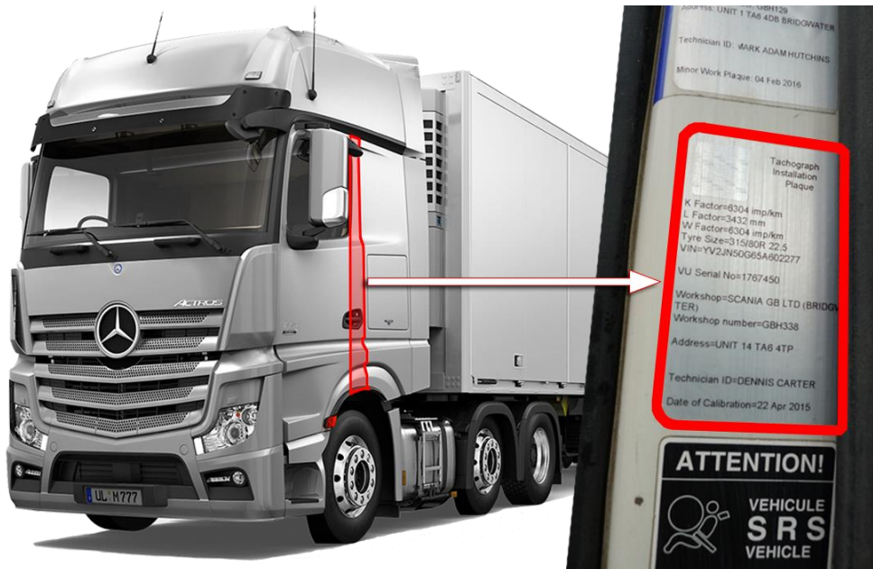
Слика 227. Постављање информативне налепнице на „В” стубу возила
