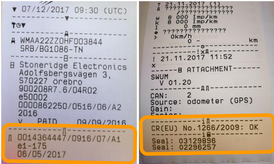
Слика 200. Провера на испису техничких података дела који се односи на сензор кретања и IMS
