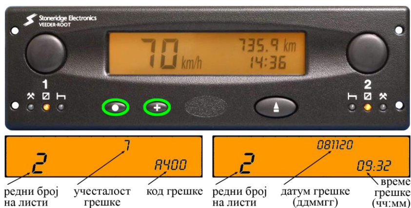
Слика 171. Листа системских грешака на дисплеју TVI 2400 [23]
