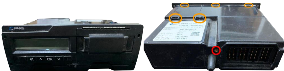
Слика 122. Изглед DT-101 турског произвођача Pars Ar-Ge спреда и позиције пломбе са жигом за преглед (црвено) на поклопцу конектора и сигурносних жабица [29]
