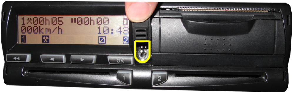
Слика 118. Позиција прикључка за преузимање података, преглед и подешавање тахографа Smartach [28]
