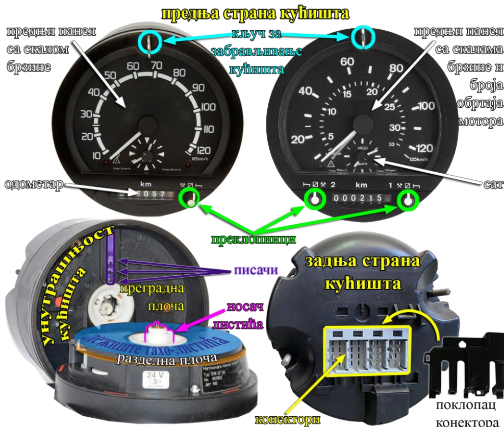
Слика 10. Спољни и унутрашњи делови кућишта АТ кружног облика
