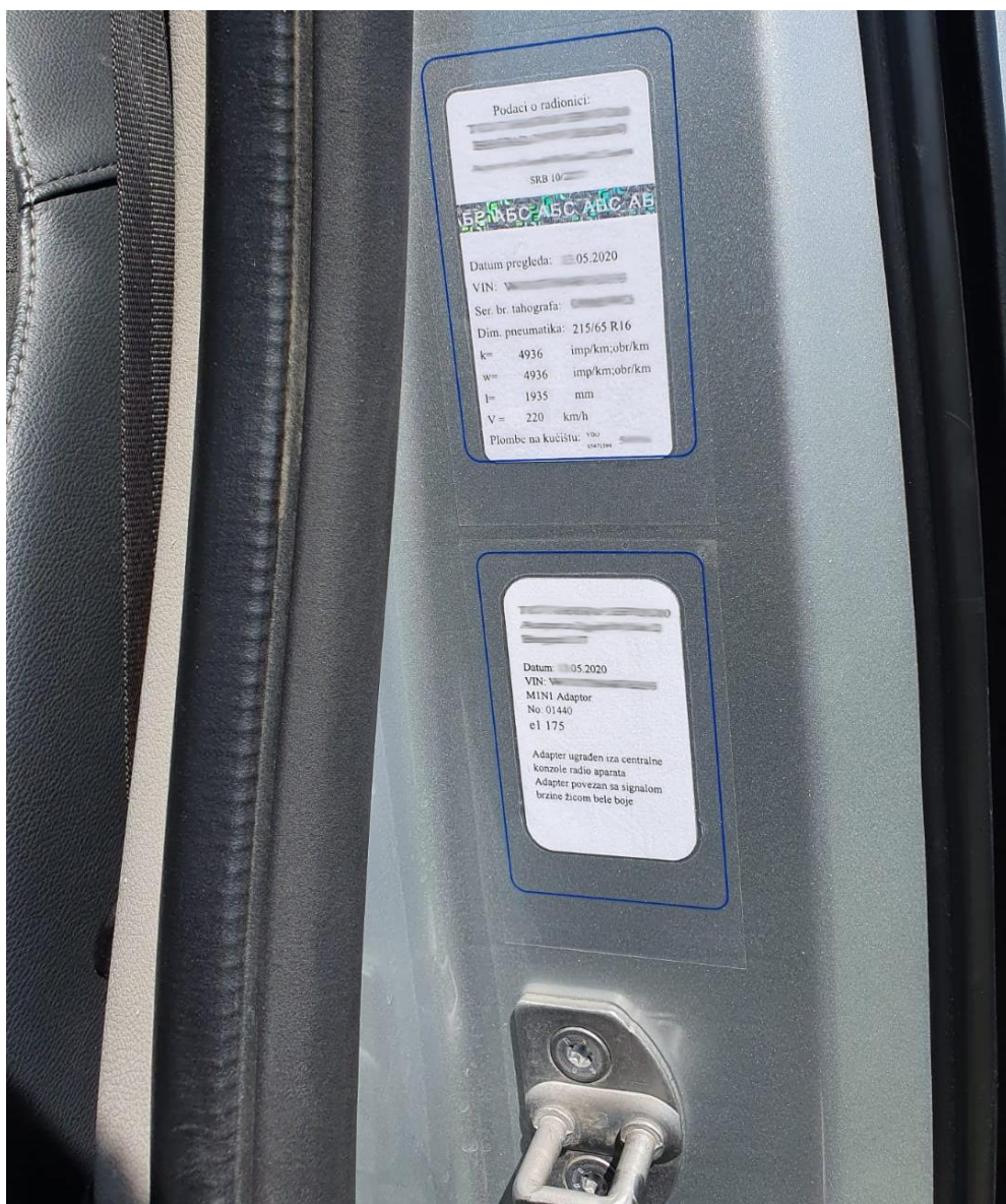
Слика 231. Начин постављања и заштите информативне налепнице и додатне информативне налепнице о MINI адаптеру
