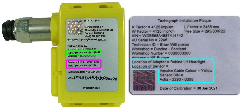
Слика 230. Изглед M1N1 адаптера, натписне налепнице са ознакама одобрења типа адаптера (зелено) и сензора (циклама) и додатне информативне налепнице [37]
