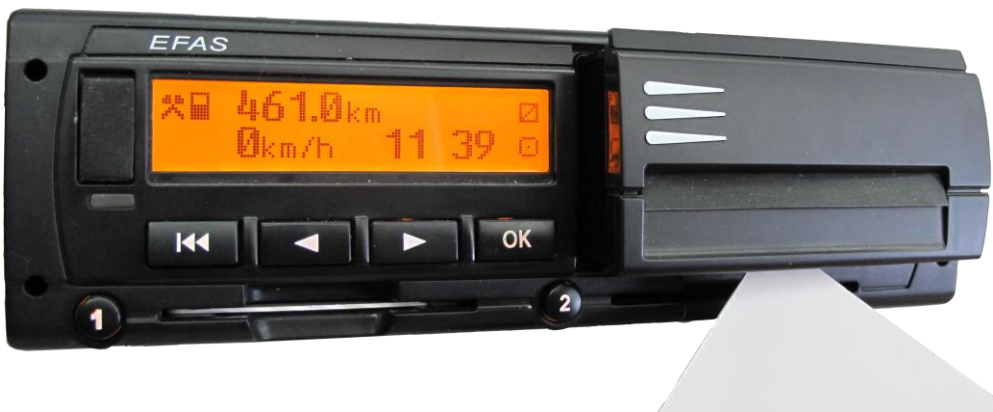
Слика 91. Начин вађења штампача ради замене или убацивања термалног папира [25]
