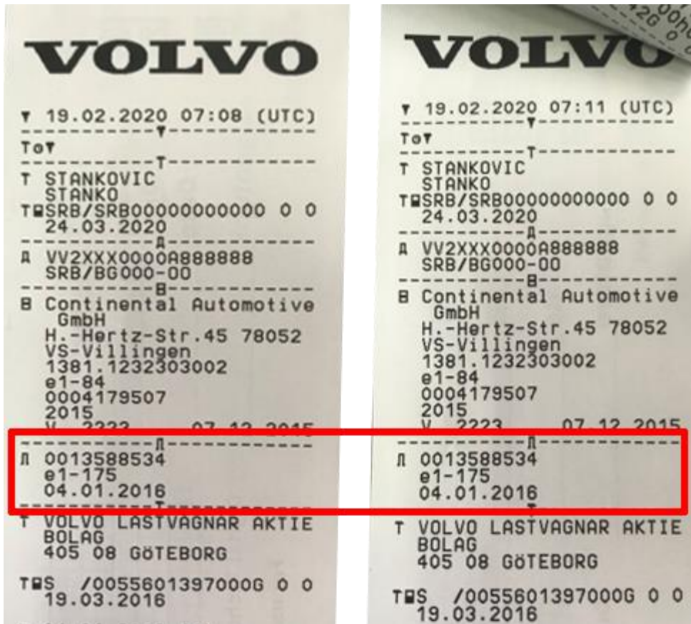
Слика 206. Упоредњавање садржаја првог (лево) и другог (десно) исписа техничких података ( T▼ ) у делу исписа који се тиче сензора кретања
