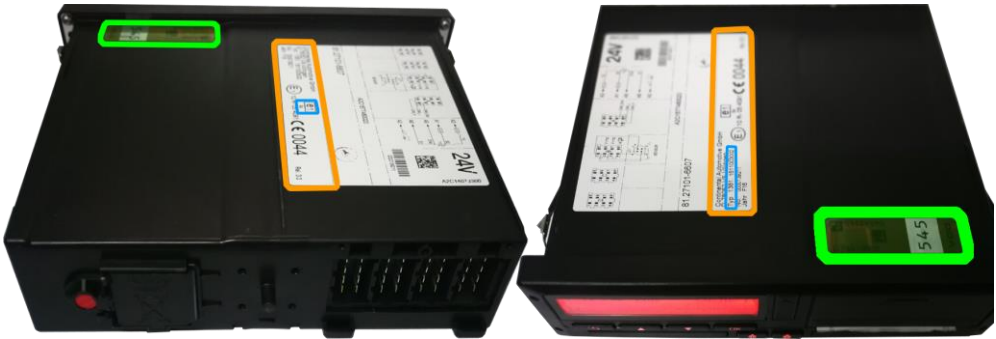
Слика 84. Изглед DTCO 1381 серије 3.0 отпозади и спреда одозго и позиција сервисне холограмске заштите кућишта (04243545) и натписне плочице (налепнице) [12]
