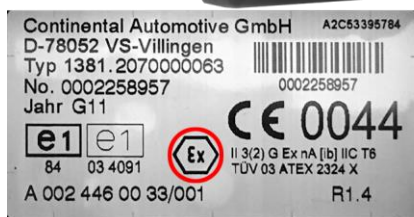
Слика 78. Положај Ex ознаке на маски јединице у возилу (ДТ намењеног за уградњу у возила за превоз опасних материја по АDR) и натписној плочици DTCO 1381 [12]
