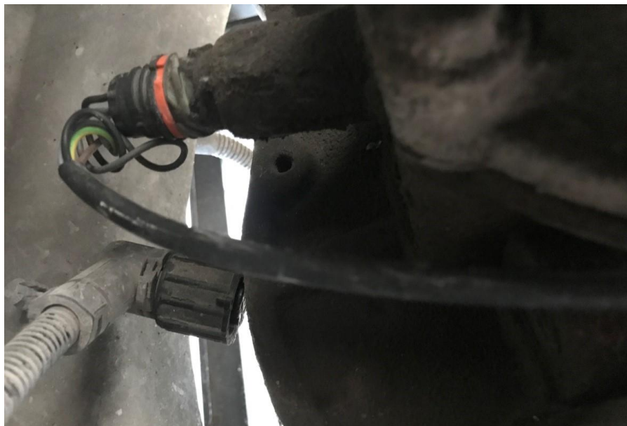
Слика 205. Повезивање јединице у возилу ДТ и сензора кретања спољним „тест” каблом
