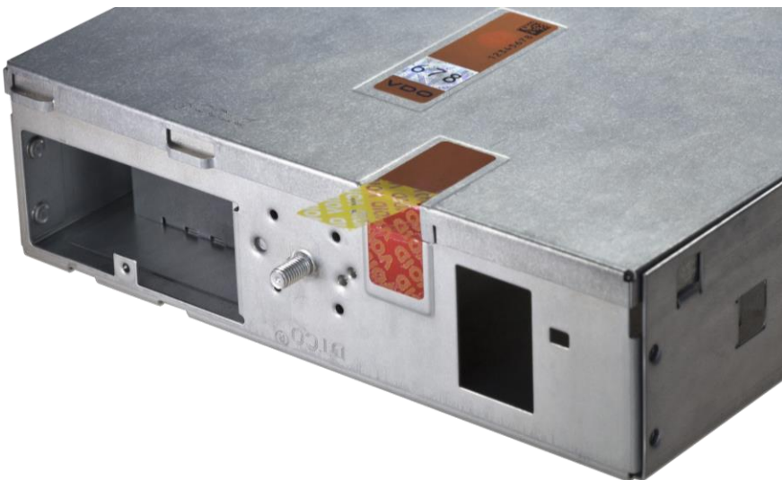
Слика 86. Оштећена сервисна холограмска заштита кућишта DTCO 1381 [12]
