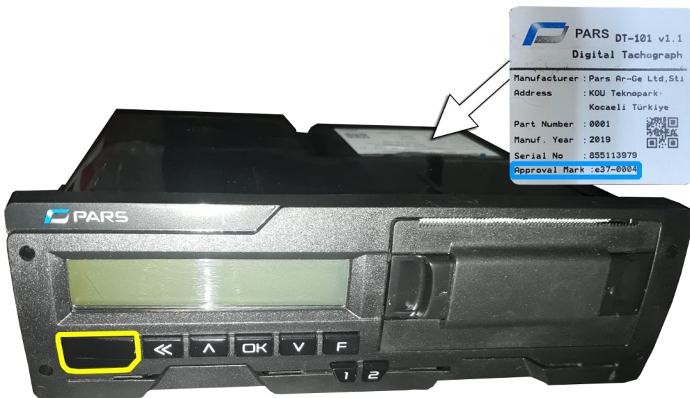
Слика 120. Изглед и локација натписне плочице (налепнице) и прикључка за преузимање података, преглед и подешавање DT-101 турског произвођача Pars Ar-Ge [29]
