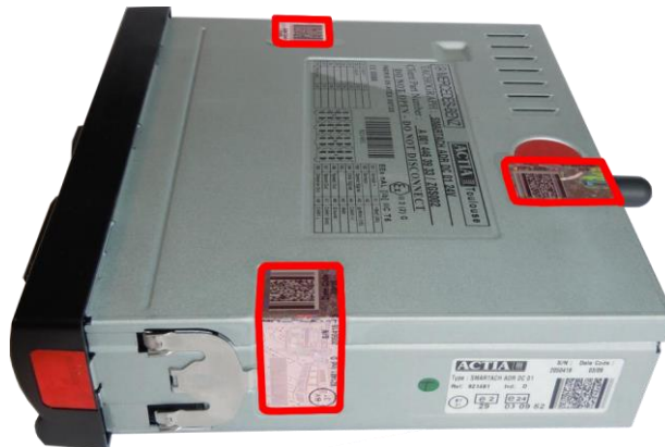
Слика 119. Локација заштитних (холограмских) налепница на кућишту ДТ Smartach [28]
