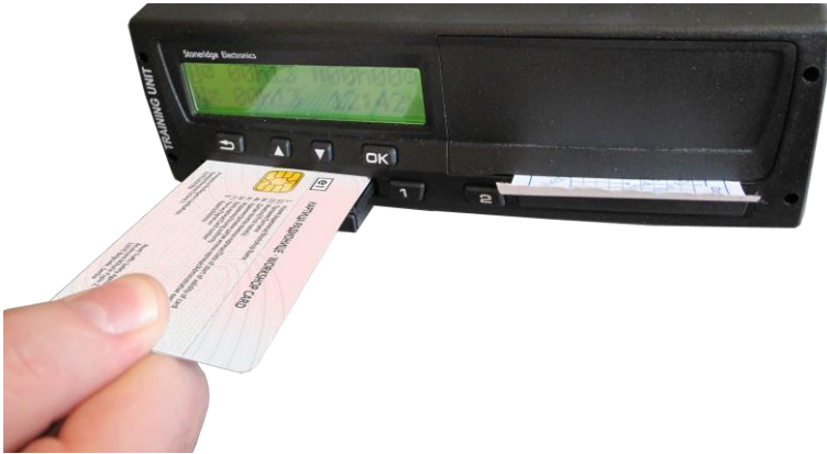
Слика 217. Поступак уметања (убацивања) картице радионице у ДТ [22]
