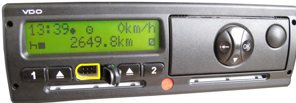
Слика 79. Положај и изглед прикључка за преузимање података, преглед и подешавање прве, друге и треће верзије DTСO 1381 серије 1.0 до 2.1 [12]
