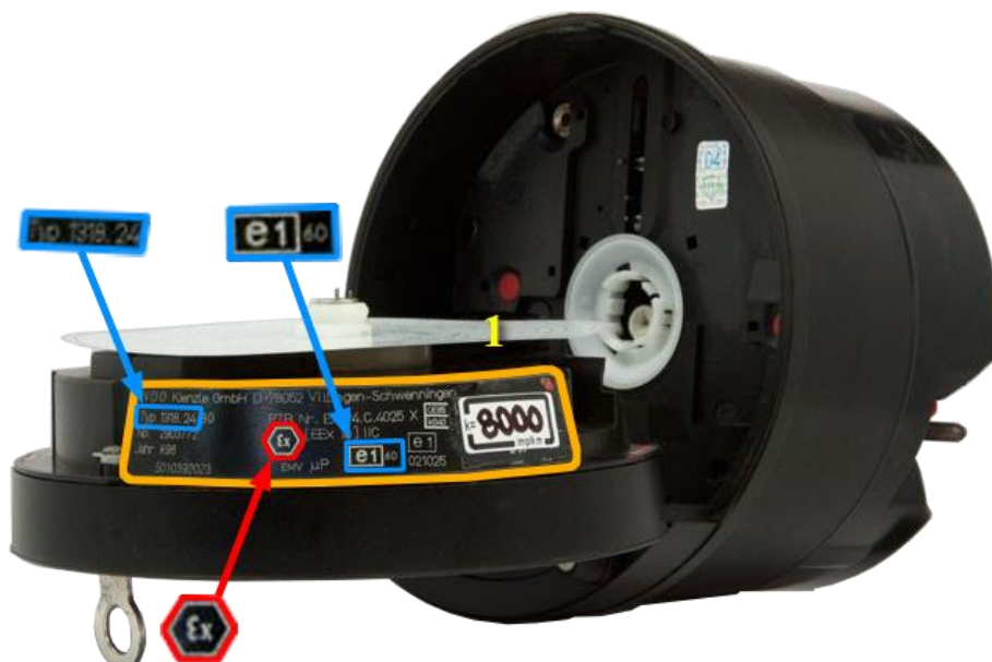
Слика 17. Позиција тахографског листића возача 1, изглед и садржај натписне плочице KTCO 1318-24 са одобрењем типа e1-60 и националном ознаком B-03-008
