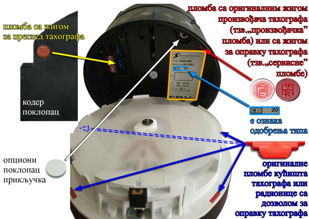
Слика 30. Пломбе и натписна плочица у јединици у возилу TVI 8400 са одобрењем типа e11-20 и националном ознаком одобрења B-03-021 [16]
