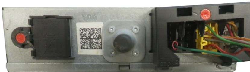
Слика 82. Изглед DTCSO 1381 од верзије 1.0 до 2.1 отпозади са позицијом пломби са жиговима за преглед тахографа [12]
