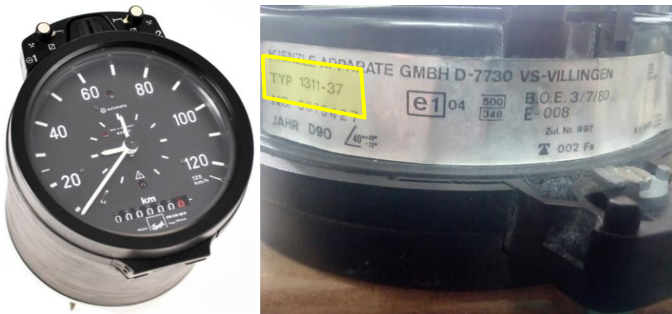
Слика 65. Изглед и натписна плочица (налепница) 1311 одобрења типа e1-04 [12]
