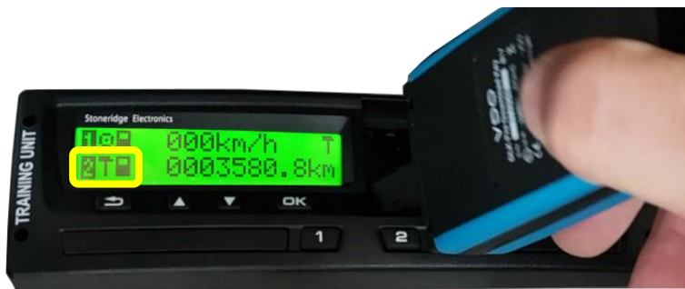
Слика 220. Преузимање података са картице радионице преко ДТ уз помоћ уређаја (кључа) за преузимање података [22]
