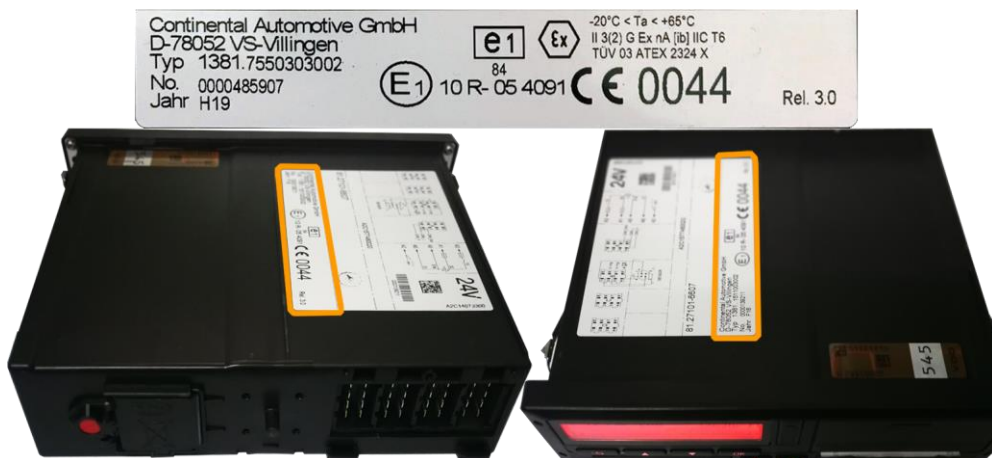
Слика 76. Изглед и локација натписне плочице на DTСO 1381 од серије 3.0 [12]
