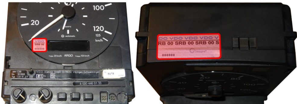
Слика 44. Нумерисане заштите на јединици у возилу FTCO 1319 [12]
