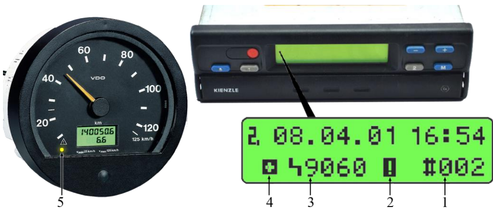
Слика 170. Приказ системских грешака и упозорења на дисплеју МТСО 1324 [33]
