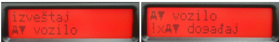
Слика 202. Улазак у мени штампања исписа и проналажење исписа догађаји и грешке из меморије тахографа (! x A T) [12]
