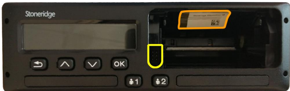
Слика 135. Локације интерфејса/конектора и заштитне (холограмске) налепнице у простору за штампач SE5000-8 [22]
