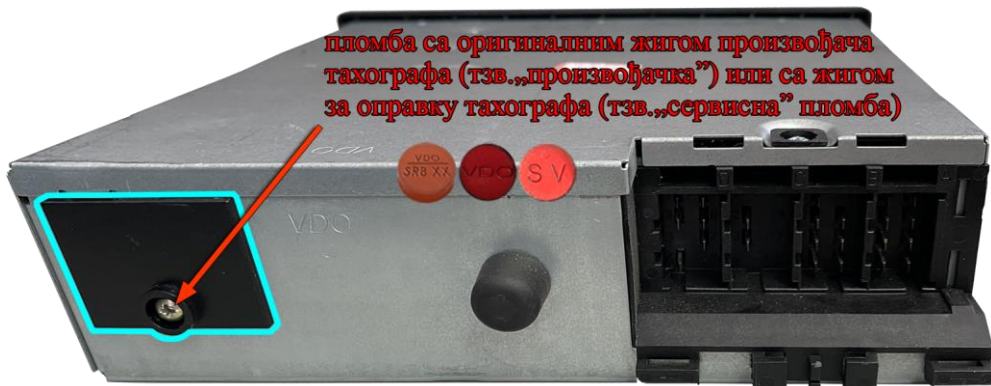
Слика 57. Позиција преграде за батерију на задњој страни МТСО 1324 и пломбе [12]
