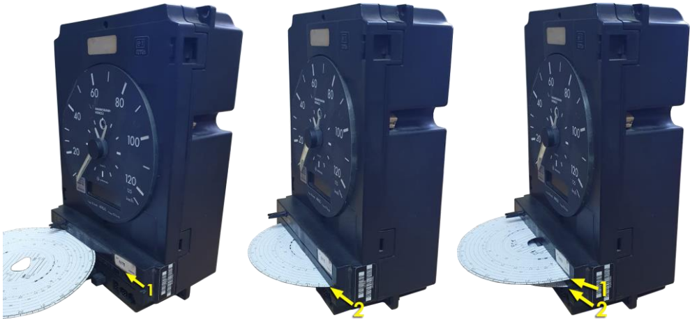
Слика 40. Уметање и позиција тахографских листића возача 1, возача 2 и оба возача у јединицу у возилу FTCO 1319 [12]
