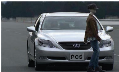
Слика 49. Испитивање противмера у судару с пешацима 70
