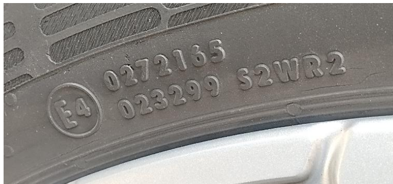
Слика 8. Пример хомологационе ознаке пнеуматика (Видети коментар испод слике 4)
