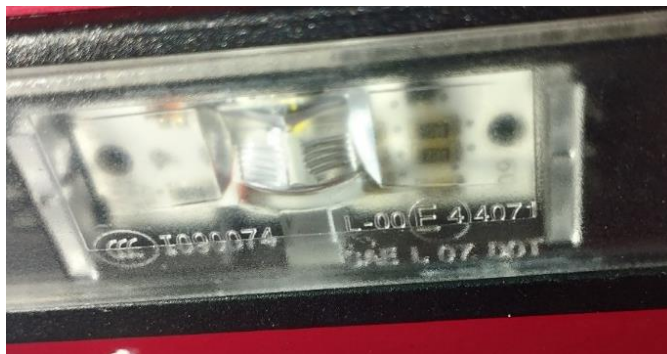
Слика 4. Пример хомологационе ознаке светла задње регистарске таблице (L-00 E4 4071, велико слово E и бројчана ознака земље у којој је издато одобрење унутар круга су иницијални показатељ да је уређај хомологован)
