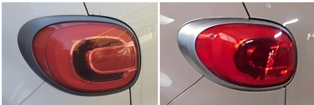
Слика 7. FIAT 500L – задња светлосна група (лево – ЕУ тржиште, десно – тржиште САД) (Иако на први поглед идентичне, светлосне групе се разликују пре свега у томе што је пластично сочиво показивача правца на левој фотографији провидно, док је на десној црвено)
