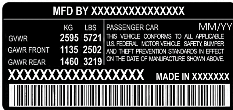
Слика 2. Пример произвођачке таблице (возило за тржиште САД)
