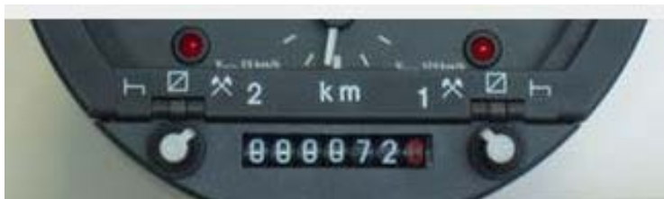
Слика 44. Преклопници за одабир активности на аналогном тахографу
