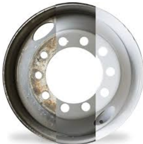
Слика 24. Фотографија фелне аутобуса пре, током и после чишћења кочионе прашине
