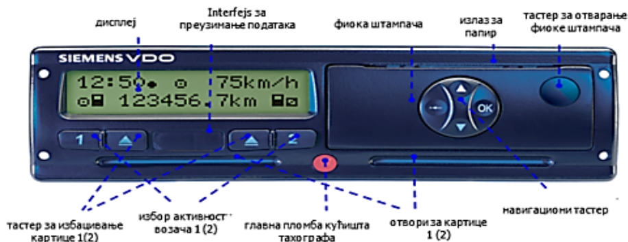
Слика 52. Изглед и опис функција тахографа VDO DTSC 1381
