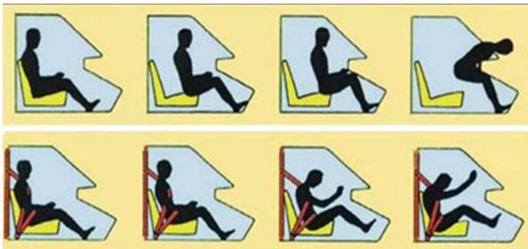
Слика 85. Функција сигурносног појаса у возилу
