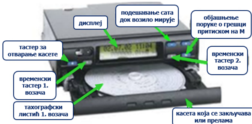
Слика 43. Изглед стандардног и модуларног аутоматског тахографа
