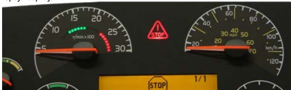
Слика 31. Обртомер аутобуса са приказаним „зеленим – еко“ модом
