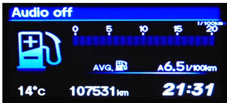
Слика 30. Путни рачунар са приказом тренутне и просечне потрошње
