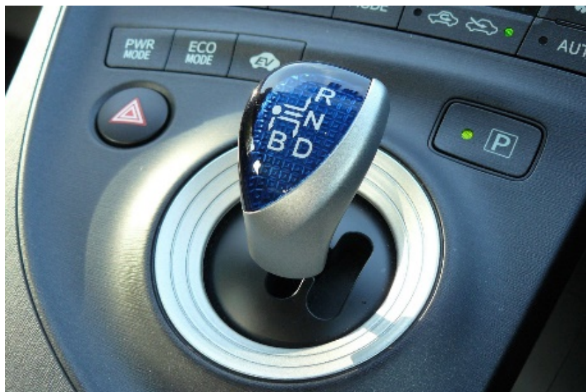
Слика 9. Ручица и прекидачи модова рада аутоматске трансмисије
