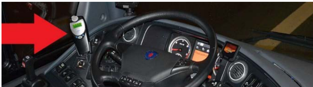
Слика 88. Приказ уређаја за контролу алкохолисаности возача и блокаду покретања рада мотора
