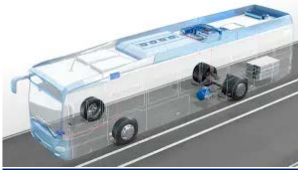
Слика 8. Шема трансмисије аутобуса
