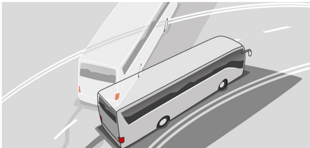
Слика 87. Приказ функционисања ЕСП уређаја
