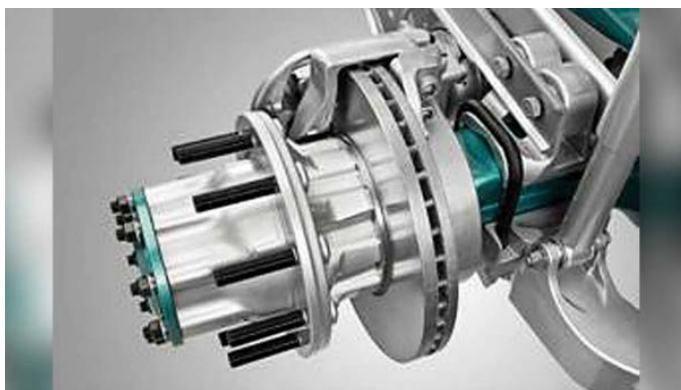
Слика 20. Диск кочница аутобуса
