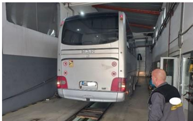
Слика 4.7 Провера функционалности светала за вожњу уназад на примеру возила врсте M3
