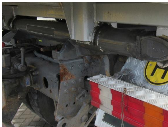
Слика 9.13 Део шасије за који се причвршћује носач уређаја захваћен корозијом
