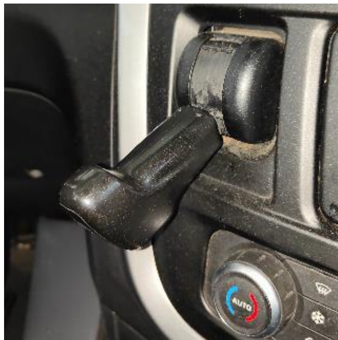
Слика 3.21 Команда подсистема за паркирно кочење (у активаном стању)
