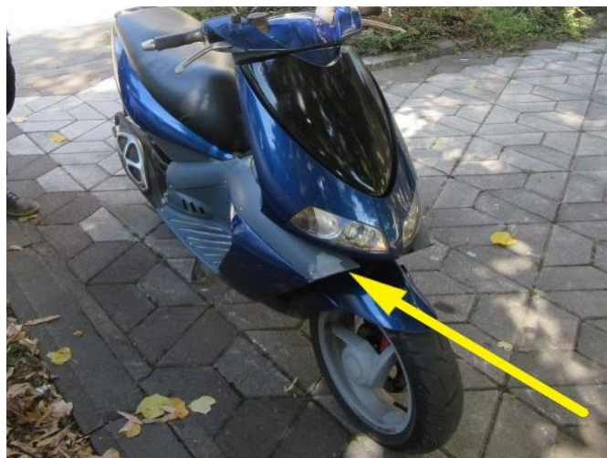
Слика 1.33 Приказ могуће позиције произвођачке таблице возила врсте L1
