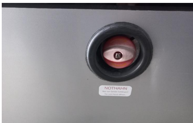
Слика 16.10 Прекидач за отварање врата са спољашње стране у случају опасности
