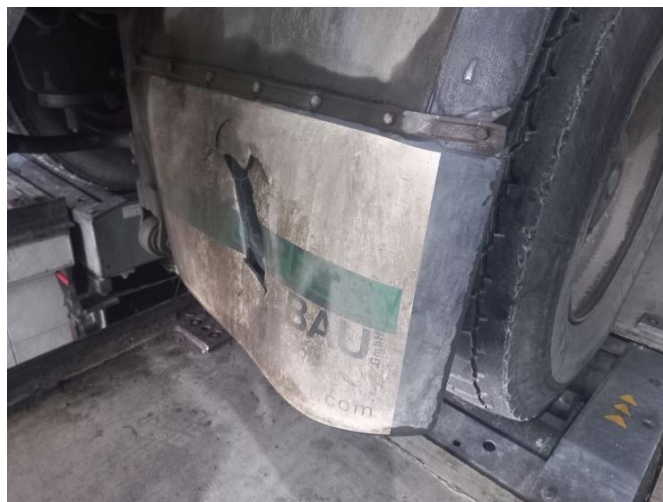
Слика 16.22 Оштећење гуменог додатка блатобрана – није неисправност
