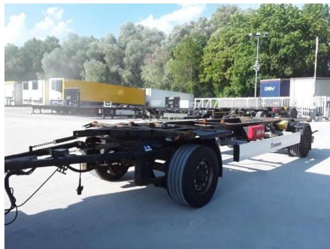
Слика 16.21 Возило врсте O чији предњи точкови нису покривени блатобранима са предње стране
