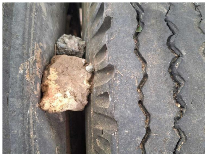
Слика 12.6 Странo тело између два пнеуматика
