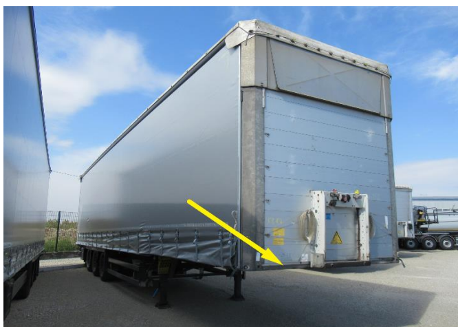
Слика 1.6 Приказ могуће позиције идентификационе ознаке возила врсте O4
