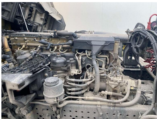
Слика 14.1 Пример теретног возила код којег је за приступ мотору потребно подизање кабине
