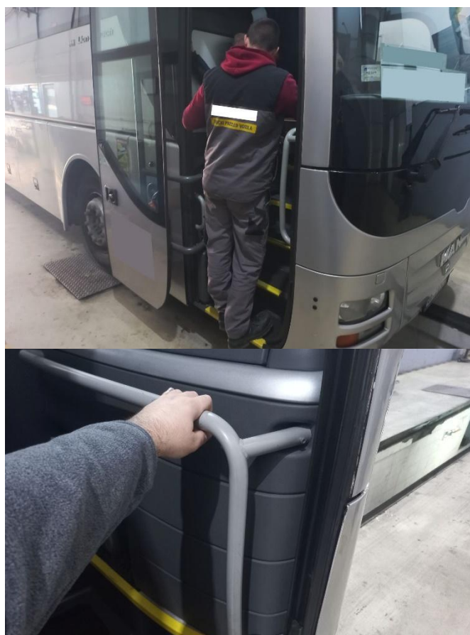
Слика 16.45 Провера постојања (лево) и причвршћености (десно) рукохвата који потпомажу улазак у возило
