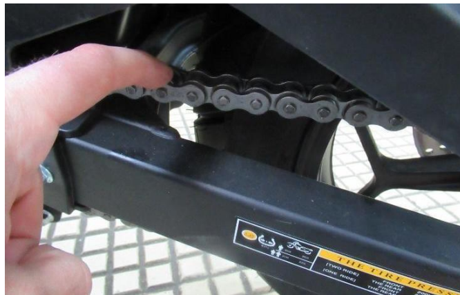
Слика 15.6 Провера ланца на возилу врсте L3
