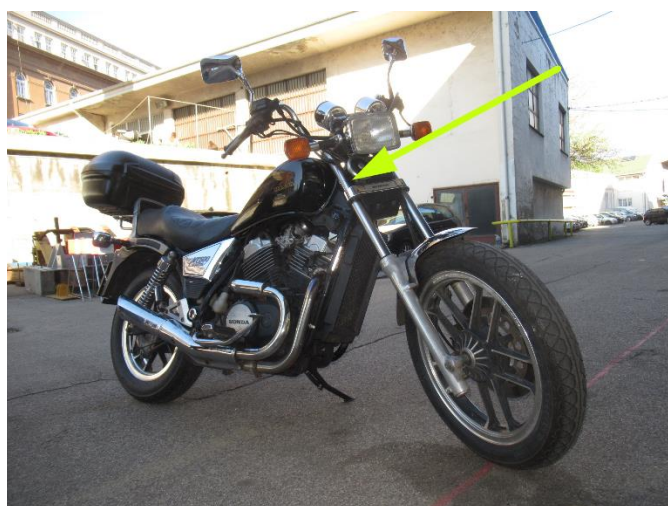
Слика 1.12 Приказ могуће позиције идентификационе ознаке возила врсте L3
