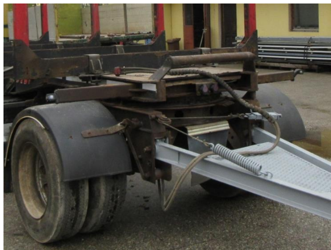
Слика 2.9 Приказ управљачког механизма прикључног возила са обртним постољем
