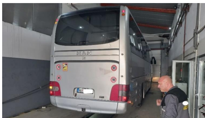
Слика 4.16 Провера функционалности задњих показивача правца на примеру возила врсте M3
