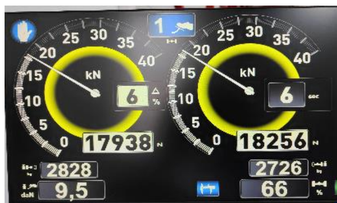
Слика 3.32 Мерење сила кочења, силе на команди, тежине по точку, разлике сила кочења по осовини
