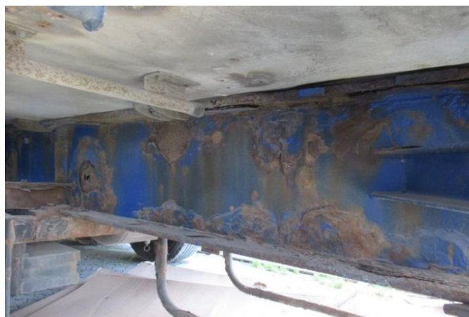
Слика 16.3 Пример дубинске корозије на подужном носачу као носећем делу шасије возила врсте О
