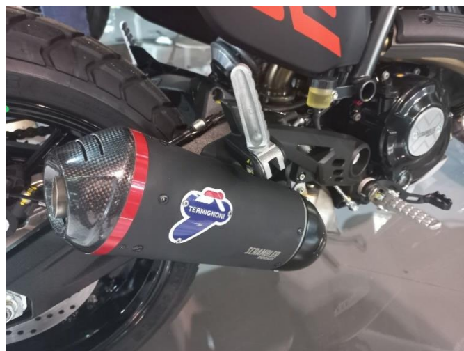
Слика 8.3 Пример карактеристичног издувног „лонца“ који је уграђен као део оригиналне фабричке опреме
