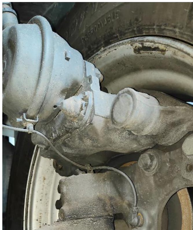
Слика 3.3 Кочни цилиндар и давач броја обртаја точка
