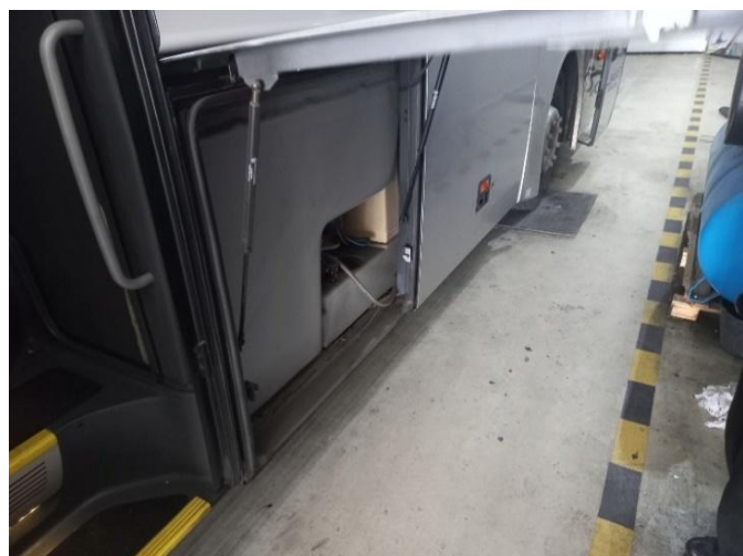
Слика 16.13 Провера задржавања поклопаца у отвореном положају помоћу предвиђеног механизма
