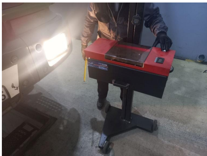
Слика 4.5 Провера главних фарова на реглоскопу
