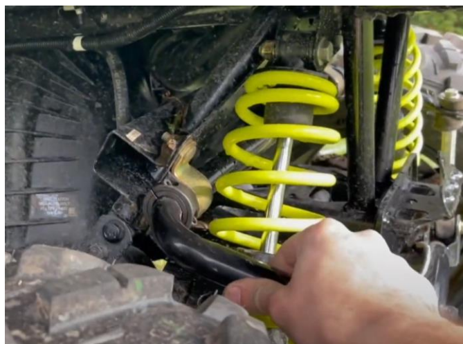
Слика 11.17 Провера стабилизатора на возилу категорије L7
