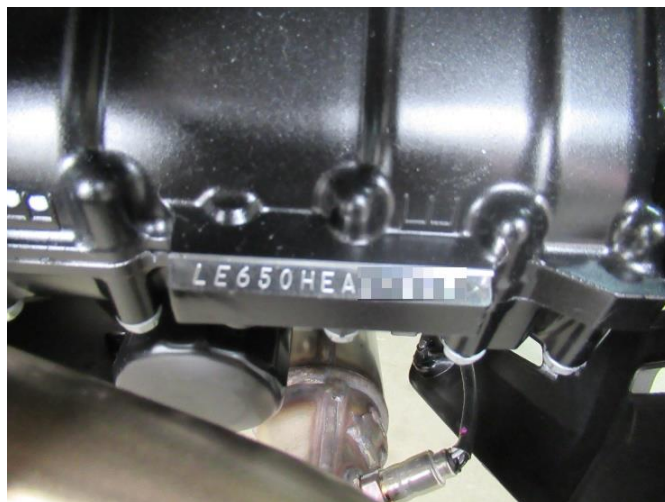
Слика 1.19 Приказ могућег изгледа идентификационе ознаке мотора возила врсте L3 (пример возила са слике 1.18)
