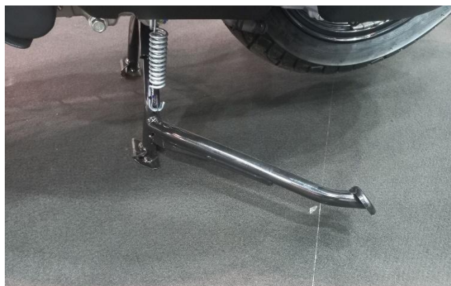
Слика 16.52 Провера централног уређаја за паркирање у усправном положају
