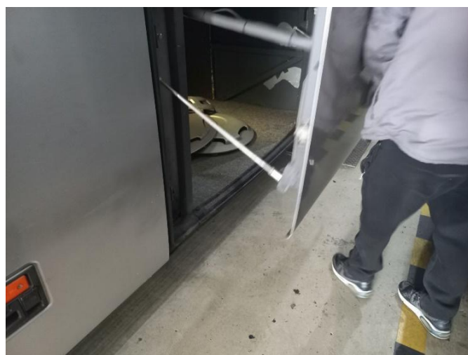
Слика 16.12 Провера целовитости и функционалности механизма за отварање и затварање поклопаца пртљажног простора
