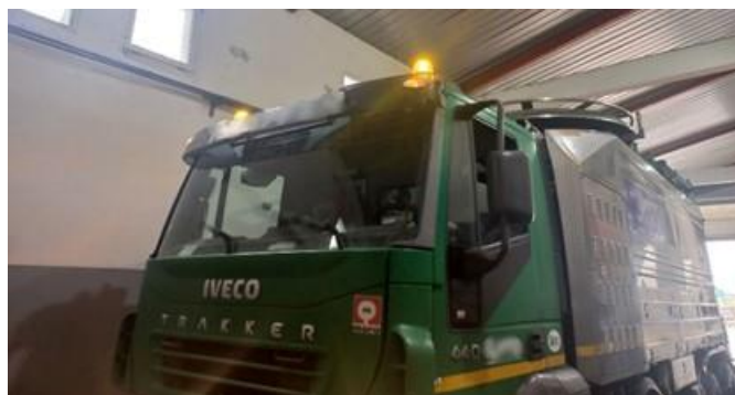
Слика 4.13 Провера функционалности жутог ротационог светла на возилу врсте N3 које се употребљава за комуналне делатности
