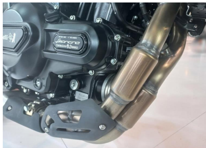
Слика 8.2 Визуелна провера издувног система на примеру возила врсте L3 (у поређењу са осталим врстама возила издувни систем је приступачнији)
