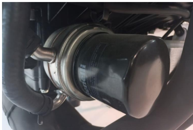
Слика 14.4 Визуелна провера евентуалних цурења на склопу филтера уља код возила врсте L3
