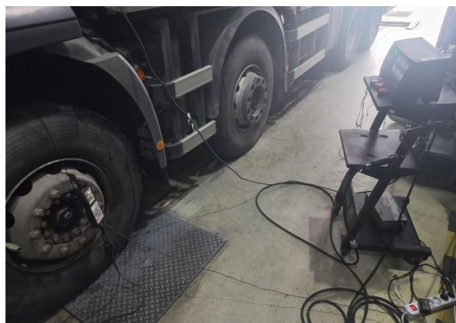
Слика 8.5 Пример повезивања уређаја са претходне слике и уређаја за мерење температуре уља и броја обртаја мотора са уређајем за испитивање издувних гасова и очитавање резултата
