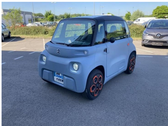
Слика 5.16 Ветробран на возилу врсте L7 са кабином
