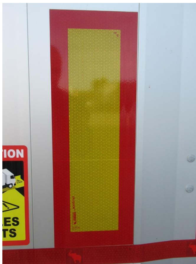
Слика 4.17 Пример ознаке дугог возила на возилу врсте O4
