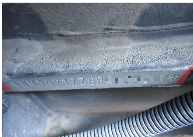
Слика 1.9 Приказ могућег изгледа идентификационе ознаке возила врсте M3 (пример возила са слике 1.8)
