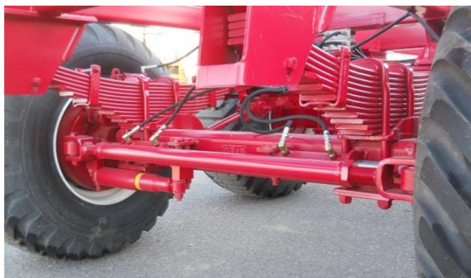
Слика 2.7 Приказ хидрауличног управљачког механизма прикључног возила
