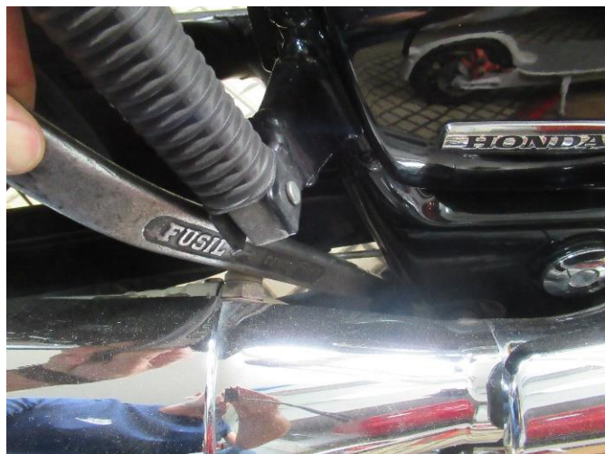
Слика 11.15 Провера елемента за вођење точка на возилу врсте L3
