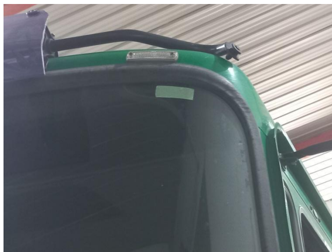
Слика 4.11 Пример габаритног светла на предњем делу возила врсте N3, постављеног на горњем делу моторног возила и на највећој могућој висини
