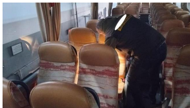
Слика 16.7 Провера седишта за путнике (присутност оштећења услед којих постоји могућност повређивања) – пример возила врсте М3
