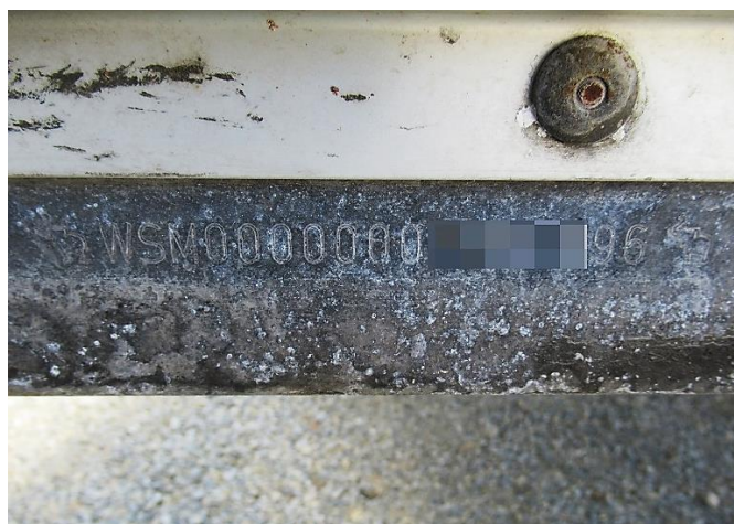
Слика 1.7 Приказ могућег изгледа идентификационе ознаке возила врсте O4 (пример возила са слике 1.6)
