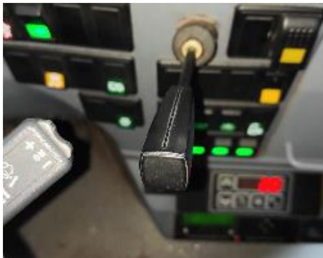
Слика 3.35 Ручна команда подсистема за дуготрајно успоравање
