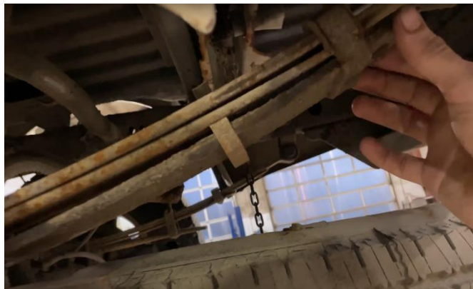
Слика 11.6 Приказ провере зазора и пластичне деформације лиснатих опруга
