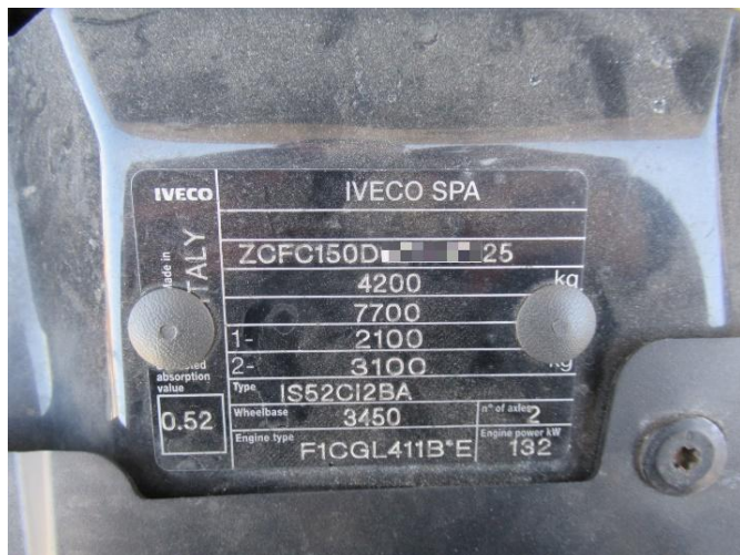
Слика 1.17 Приказ произвођачке табlice (Iveco) на ком је назначена типска ознака мотора (F1CGL411B)
