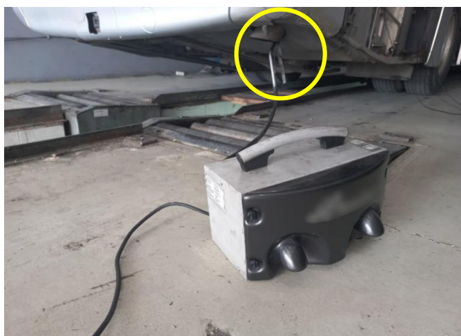
Слика 8.6 Мерна сонда за испитивање састава издувних гасова дизел мотора постављена у издувну цев и повезана са уређајем за узорковање издувних гасова – пример возила врсте M3
