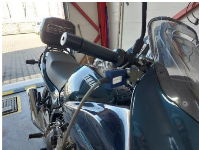
Слика 3.20 Команда подсистема за помоћно кочење – предња кочница
