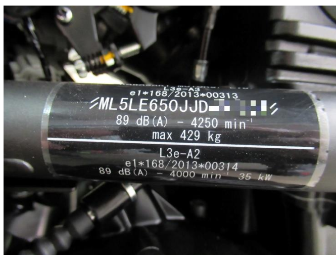
Слика 1.25 Приказ могућег изгледа произвођачке таблице возила врсте L3 (пример возила са слике 1.24)
