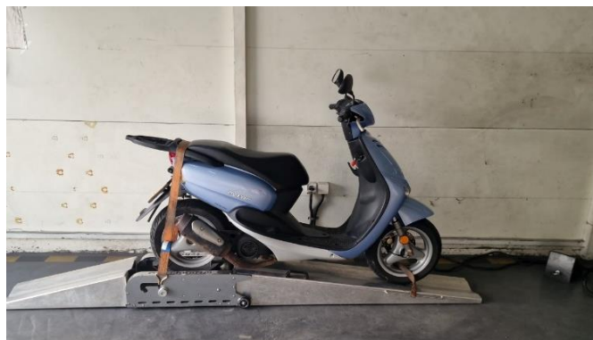
Слика 16.40 Мопед на уређају за мерење максималне брзине
