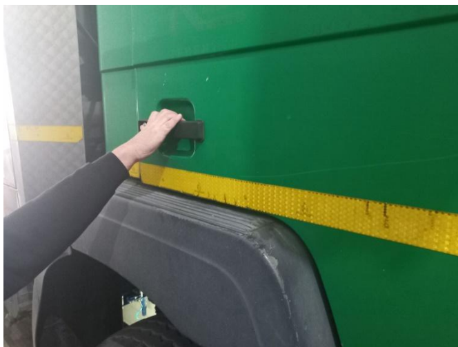
Слика 16.20 Провера функционалности браве на вратима кабине возила врсте N3
