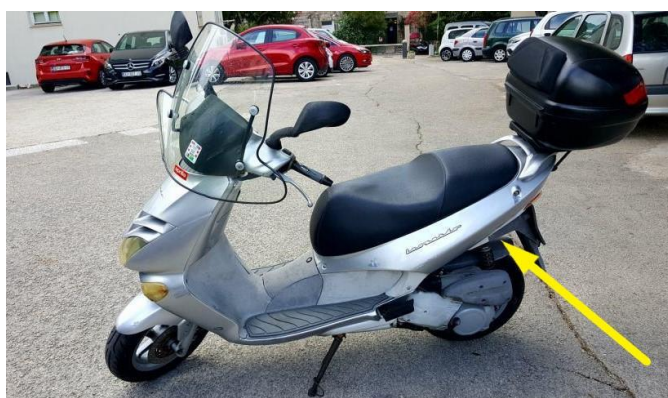
Слика 1.28 Приказ могуће позиције произвођачке таблице возила врсте L3
