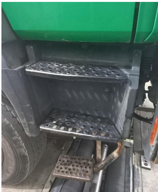
Слика 16.33 Визуелна провера степеника за улаз и излаз на возилу врсте N3
