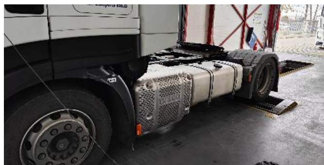
Слика 3.27 Мерење сила на кочним ваљцима
