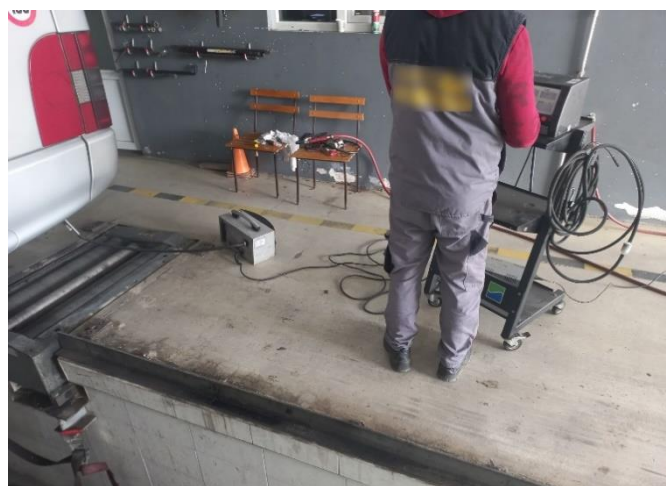
Слика 8.7 Контролор врши испитивање резултата испитивања димности издувних гасова помоћу уређаја за испитивање издувних гасова и очитавање резултата – пример возила врсте M3
