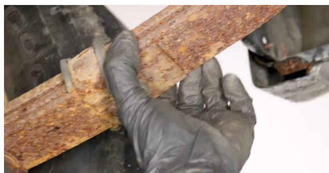
Слика 11.5 Приказ провере додатне узенгије за спајање лиснатих опруга
