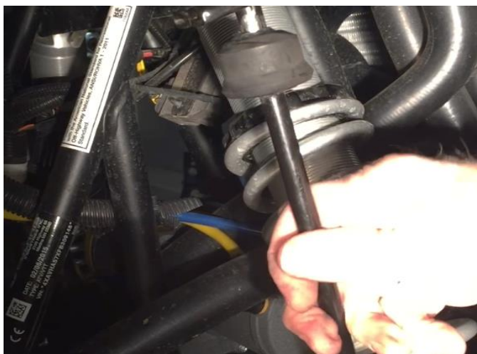
Слика 11.16 Провера стабилизатора на возилу категорије L7
