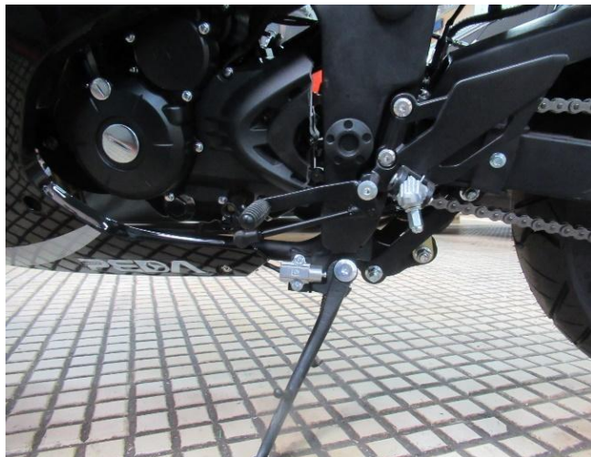
Слика 15.3 Ножна команда за промену степена преноса
