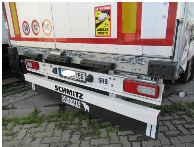
Слика 16.36 Заштитник од подлетања са задње стране на возилу врсте O4
