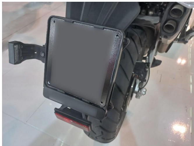
Слика 16.30 Простор за регистарску таблицу на примеру возила врсте L3 (у већини случајева се светло налази са горње стране, али постоје и овакве изведбе)
