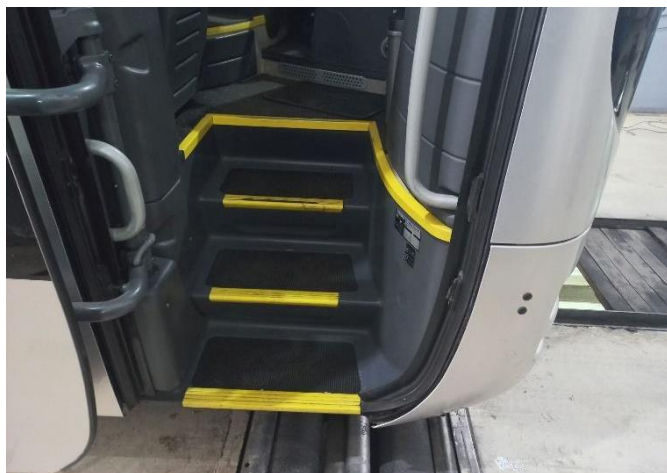
Слика 16.34 Визуелна провера степеника за улаз и излаз (врсте M3)
