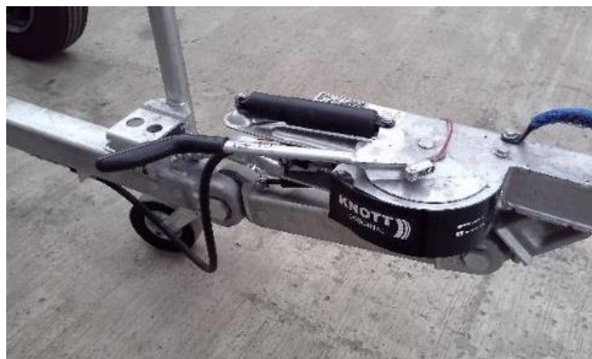
Слика 3.23 Команда подсистема за паркирно кочење –инерциони кочни систем
