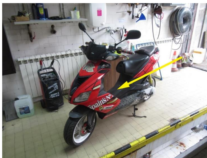
Слика 1.31 Приказ могуће позиције произвођачке таблице возила врсте L1
