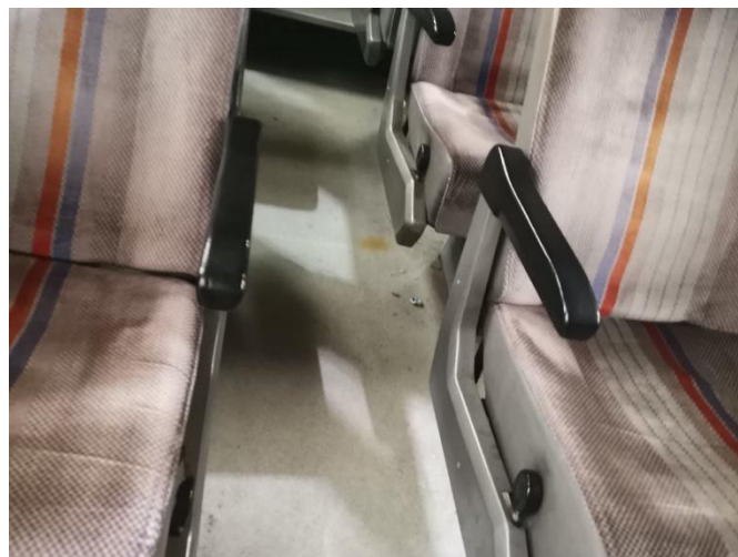
Слика 16.5 Визуелна провера пода простора за путнике на примеру возила врсте M2
