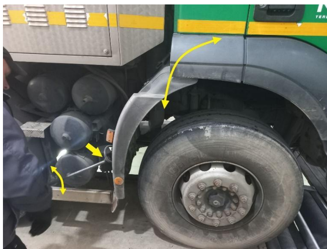
Слика 14.2 Пример провере функционалности механизма за подизање кабине теретног возила (уз коришћење полуге као дела опреме привредног друштва које врши технички преглед)
