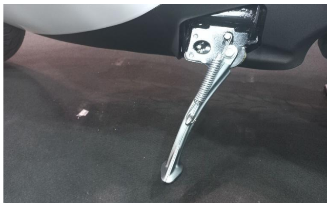
Слика 16.51 Провера бочног уређаја за паркирање у усправном положају
