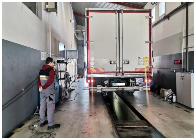
Слика 6.1 Провера функционалности уређаја за звучну сигнализацију кретања уназад на возилу врсте N2 (ознаке тешких возила нису постављене исправно – више о овоме дато је у поглављу 4)
