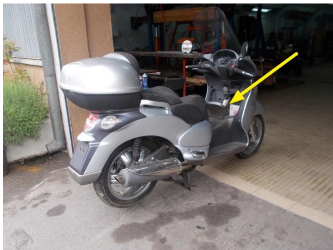
Слика 1.26 Приказ могуће позиције произвођачке таблице возила врсте L3
