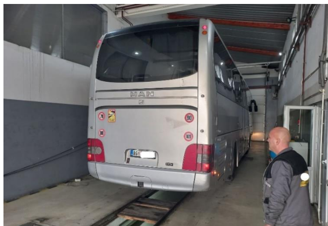
Слика 4.10 Провера функционалности задњих позиционих светала на примеру возила врсте M3
