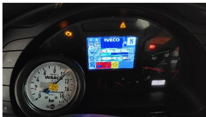
Слика 3.2 Притисци у резервоарима кочних кругова
