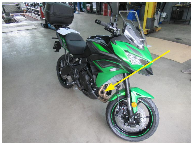
Слика 1.18 Приказ могуће позиције идентификационе ознаке мотора возила врсте L3
