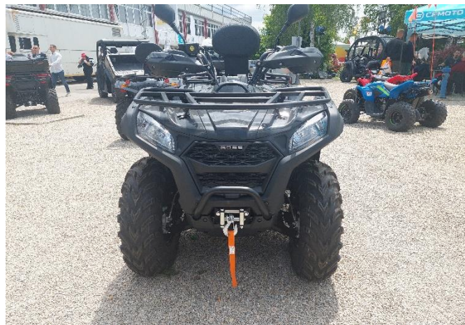
Слика 16.32 Пример возила врсте L3 са уграђеним „бул баром“
