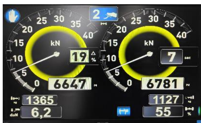
Слика 3.33 Одређивање неуједначености сила кочења по обрту точка
