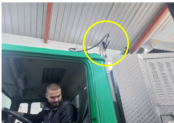
Слика 8.4 Пример постављања мерне сонде и уређаја за узорковање издувних гасова када је излаз издувне цеви изведен на највишој тачки возила врсте N3
