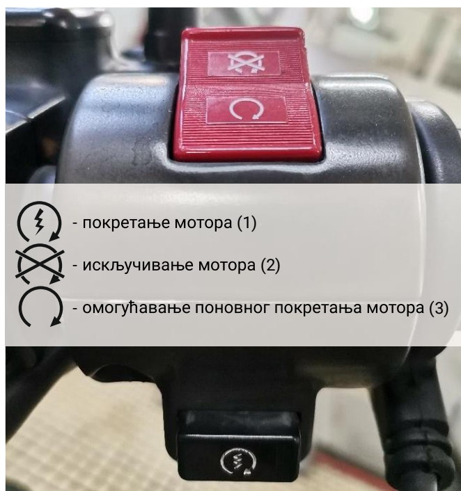
Слика 13.5 Прекидачи за покретање/искључивање и омогућавање поновног покретања мотора
