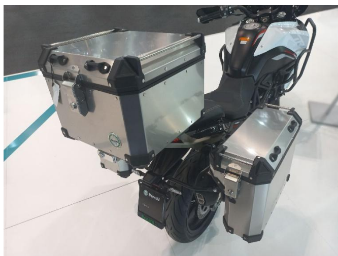
Слика 16.31 Пример возила врсте L3 са уграђеном оригиналном фабричком опремом за додатни пртљаг
