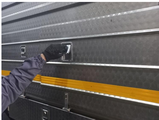
Слика 16.19 Провера поклопаца на бочној страни возила врсте N3
