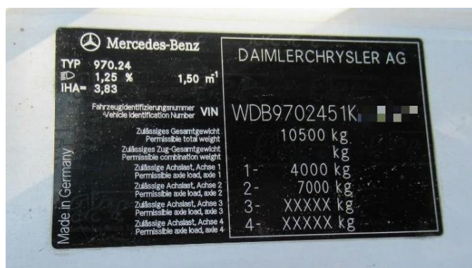
Слика 1.22 Приказ могућег изгледа произвођачке таблице возила врсте N3 - назначен је и тип возила (970.24)
