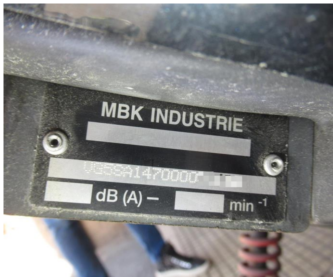
Слика 1.35 Приказ могућег изгледа произвођачке таблице возила врсте L1 (пример возила са слике 1.34)
