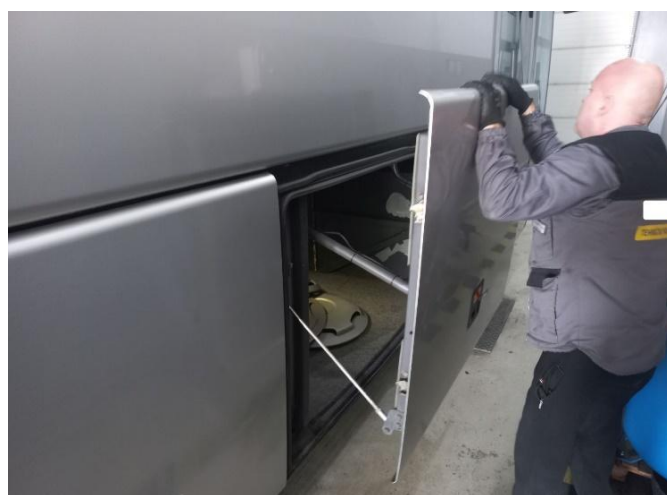
Слика 16.14 Контролор оцењује силу потребну за исправно затварање поклопаца
