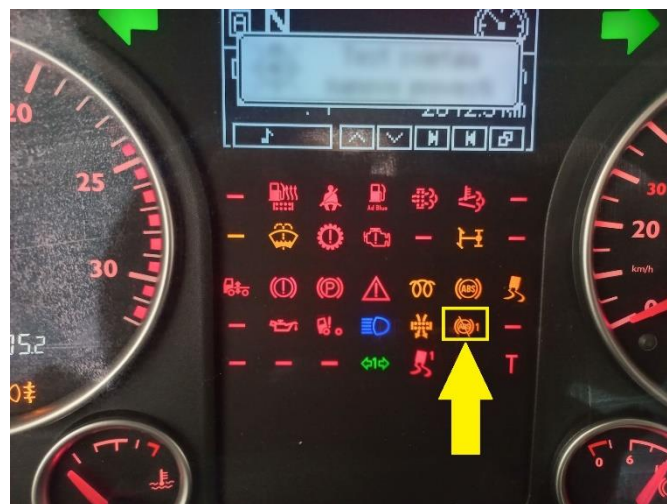
Слика 7.3 Пример оптичког индикатора за контролу исправности ABS прикључног возила (ABS1) на контролној табли вучног возила
