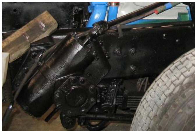
Слика 2.5 Приказ замашћених елемената управљачког механизма који не представља неисправност
