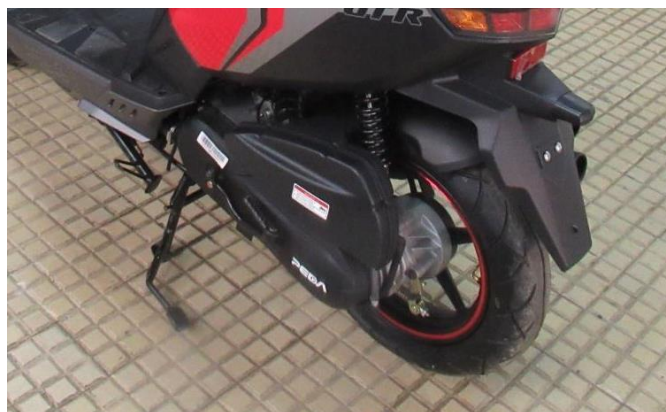
Слика 15.8 Кућиште ременог преноса на возилу врсте L1
