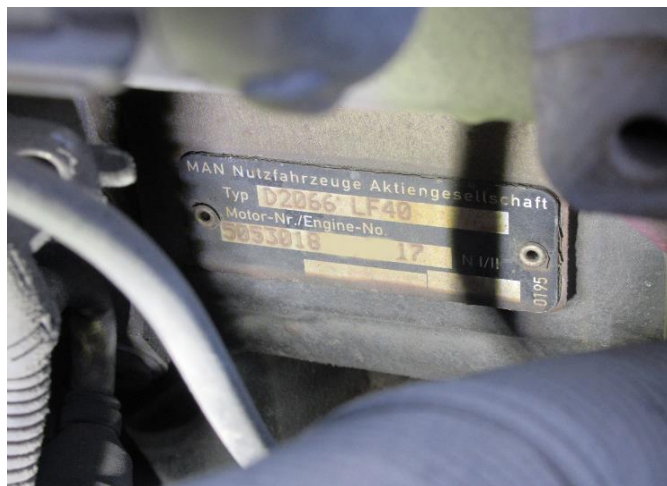
Слика 1.15 Приказ могућег изгледа плочице идентификационе ознаке мотора возила врсте N3
