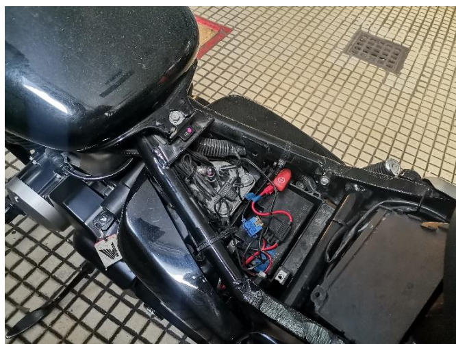
Слика 13.2 Пример положаја акумулатора возила врсте L (најчешће испод седишта)
