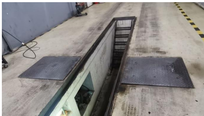
Слика 11.11 Развлачилица за возила највеће дозвољене масе веће од 3,5 t
