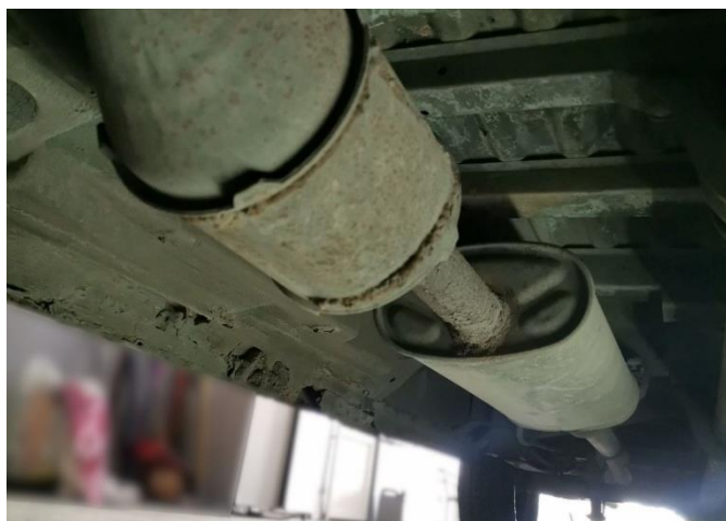
Слика 8.1 Визуелна провера издувног система на примеру возила врсте M2, док је возило на каналу
