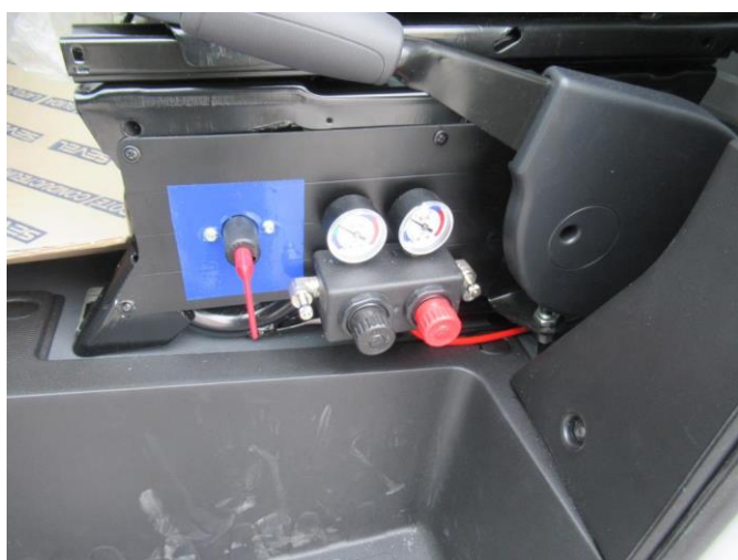
Слика 11.10 Контролни систем за регулисање притиска у ваздушном систему накнадно уграђеног система за повећање носивости возила
