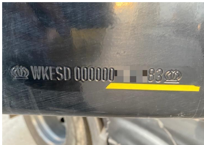
Слика 1.11 Приказ могућег изгледа идентификационе ознаке возила врсте O4 (пример возила са слике 1.10)
