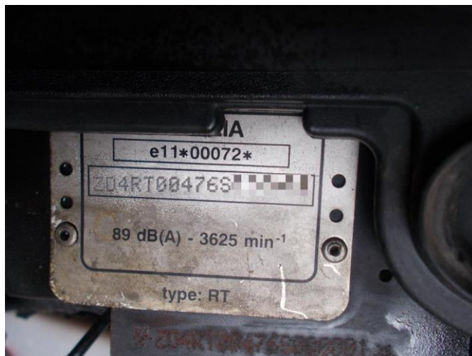
Слика 1.27 Приказ могућег изгледа произвођачке таблице возила врсте L3 (пример возила са слике 1.26)
