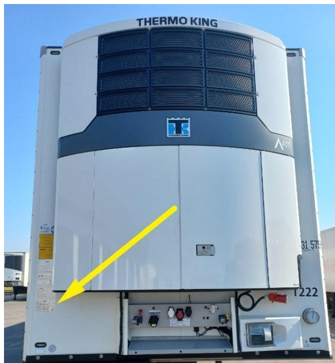
Слика 1.20 Приказ могуће позиције произвођачке таблице возила врсте O4
