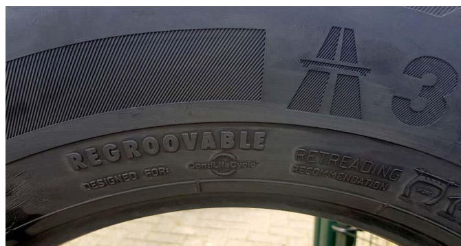
Слика 12.7 Приказ пнеуматика са ознаком „REGROOVABLE”
