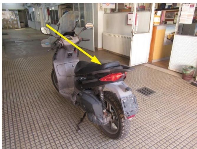
Слика 1.30 Приказ могуће позиције произвођачке таблице возила врсте L3
