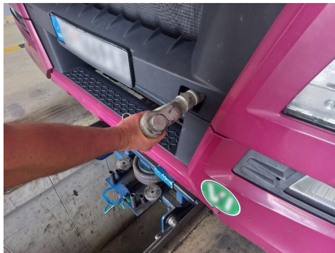
Слика 16.27 Провера функционалности прикључка за вучу на примеру тегљача за полуприколице
