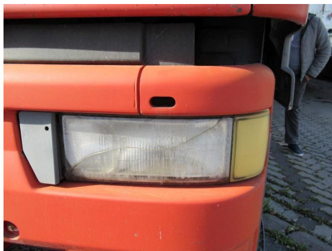
Слика 4.6 Оштећење главног фара које за последицу има изражено накупљање влаге и нечистоћа унутар фара
