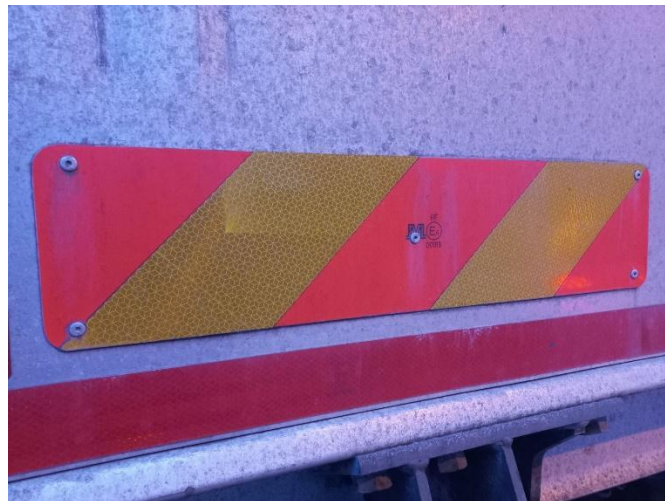
Слика 4.18 Пример ознаке тешког возила на возилу врсте N3
