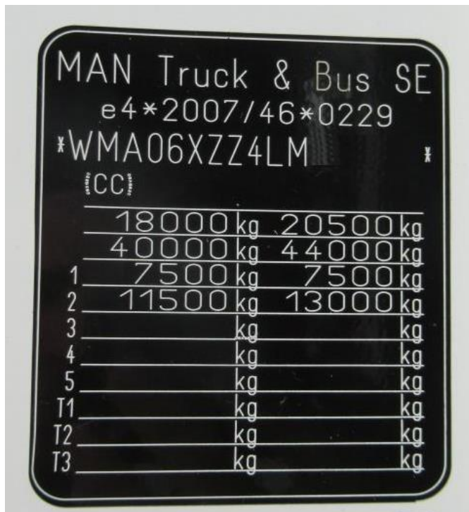
Слика 1.21 Приказ могућег изгледа произвођачке таблице возила врсте N3
