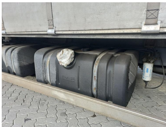
Слика 16.28 Пример резервоара за гориво код кога заптивеност није обезбеђена на одговарајући начин (возило врсте N2)
