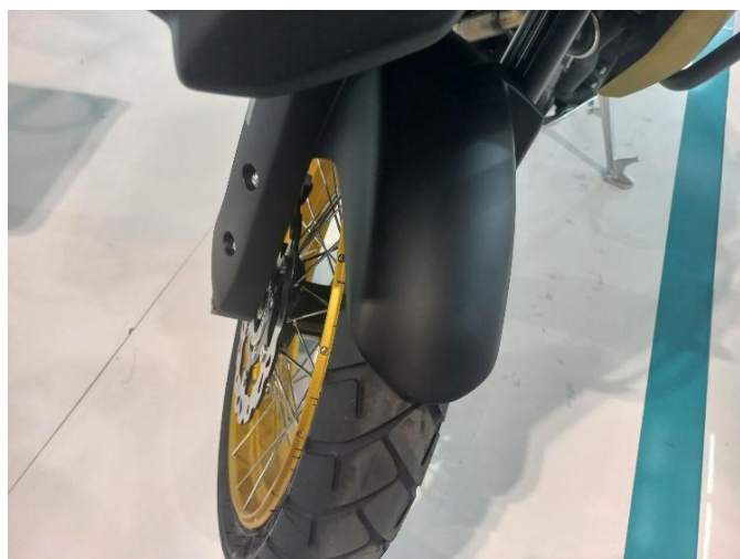
Слика 16.23 Визуелна провера предњег блатобрана на возилу врсте L3
