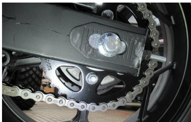
Слика 15.7 Ланац са ланчаником и механизмом за подешавање затегнутости ланца
