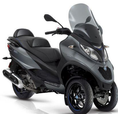
Слика 12.12 Возило врсте L са два точка од тога је један удвојен точак
