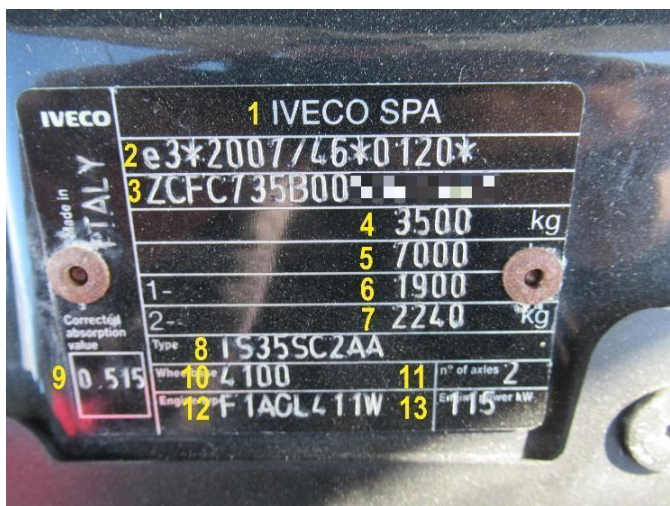
Слика 1.36 Приказ могућег изгледа произвођачке таблице са означеним елементима за појашњење
