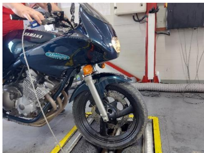
Слика 3.29 Мерење сила на команди – ручна
