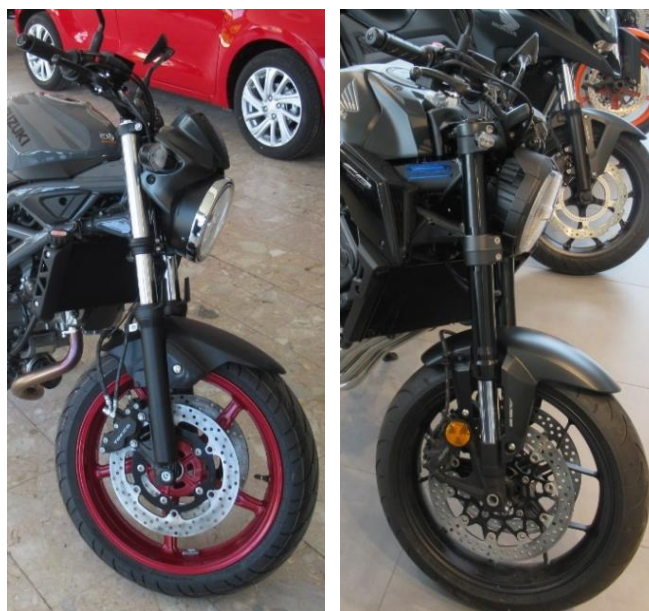
Слика 11.1 Приказ предњег ослањања возила врсте L3
