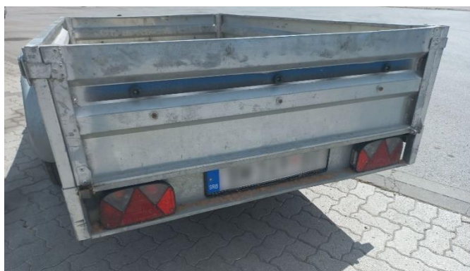
Слика 4.14 Пример прикључног возила врсте O1 – уочљива 2 задња црвена катадиоптера у облику једнакостраничног троугла, са врхом окренутим навише у оквиру задње светлосне групе
