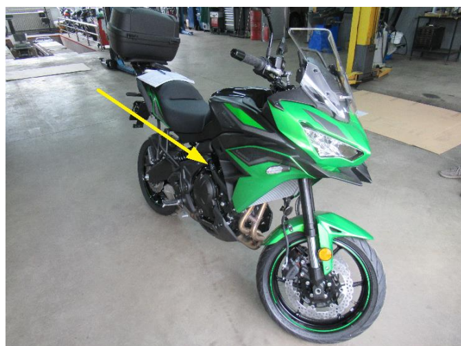
Слика 1.24 Приказ могуће позиције произвођачке таблице возила врсте L3
