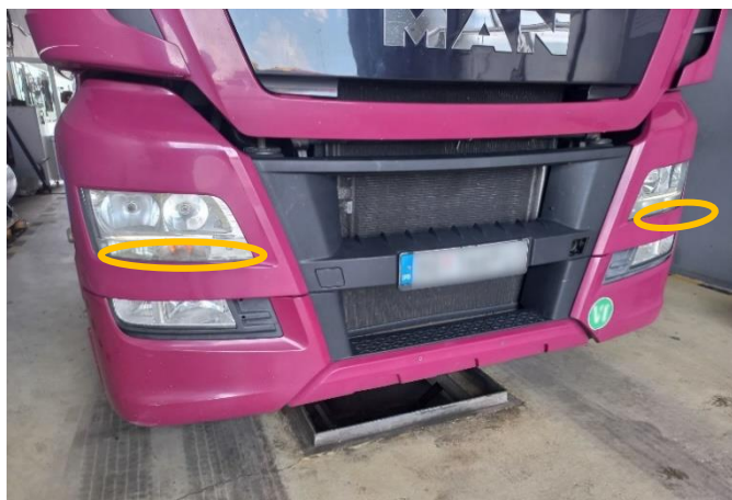
Слика 4.9 Провера функционалности предњих позиционих светала на примеру возила врсте N3
