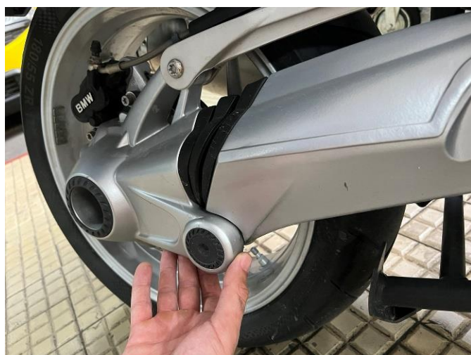
Слика 11.13 Провера елемената за вођење точка на возилу врсте L3
