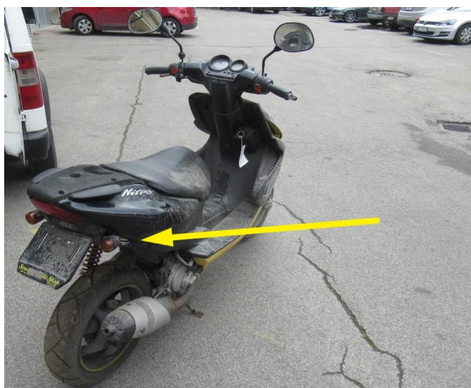
Слика 1.34 Приказ могуће позиције произвођачке таблице возила врсте L1
