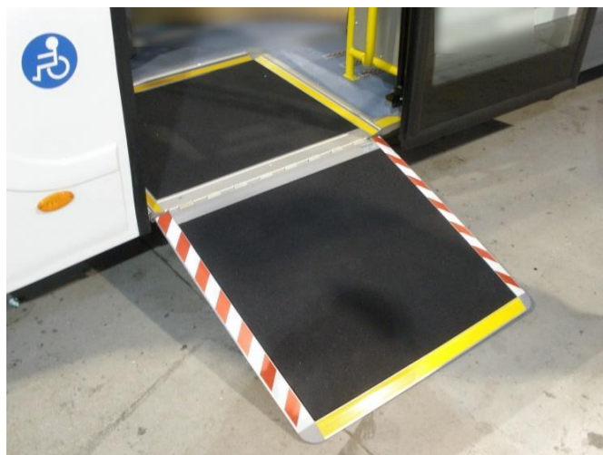
Слика 16.18 Провера функционалности опреме која омогућава приступ возилу особама у инвалидским колицима
