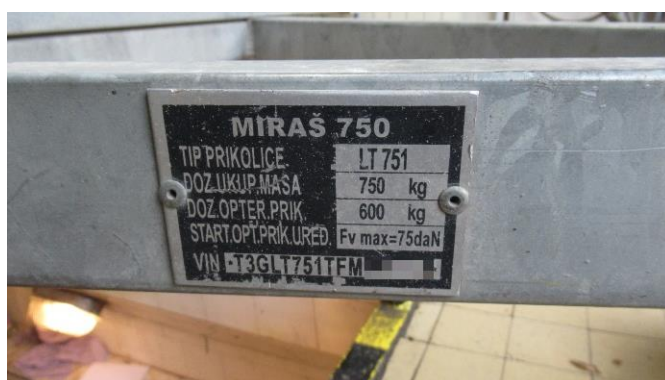
Слика 1.23 Приказ могућег изгледа произвођачке таблице возила врсте O1
