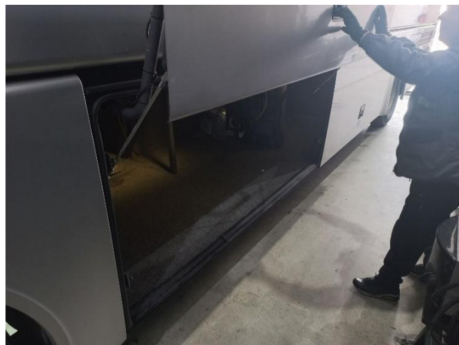
Слика 16.11 Визуелна провера поклопаца пртљажног простора
