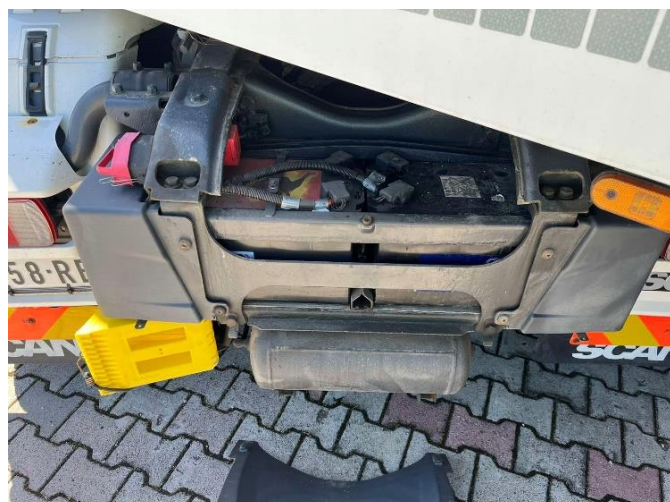
Слика 13.1 Пример положаја акумулатора возила врста N2 и N3 (кућиште између подужних носача шасије са задње стране возила – може се налазити и иза оплате са стране возила)
