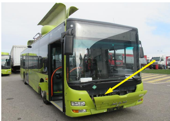
Слика 1.8 Приказ могуће позиције идентификационе ознаке возила врсте M3
