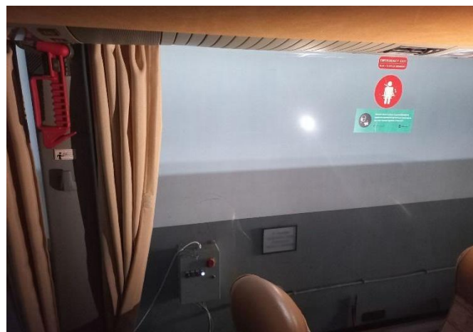
Слика 16.41 Пример прозора на десној бочној страни возила врсте M3 који служи као излаз у случају опасности
