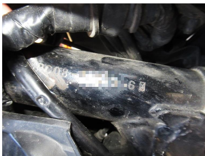
Слика 1.13 Приказ могућег изгледа идентификационе ознаке возила врсте L3 (пример возила са слике 1.12)
