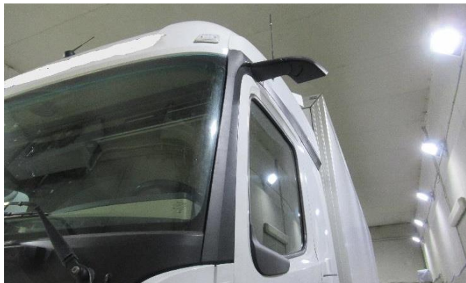
Слика 5.5 Спољашњи изглед возила са камерама уместо огледала
