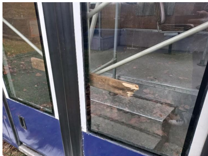
Слика 16.16 Нефункционална врата на аутобусу – у затвореном положају се одржавају помоћу страног предмета
