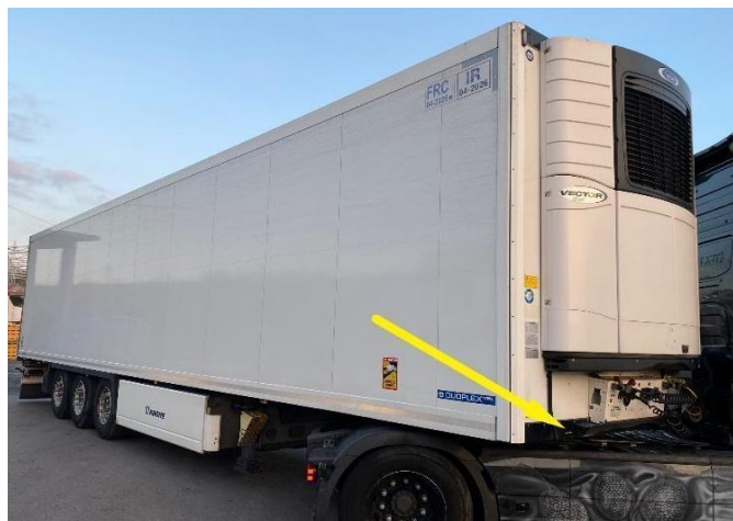
Слика 1.10 Приказ могуће позиције идентификационе ознаке возила врсте O4
