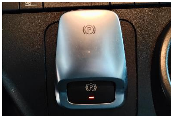
Слика 3.22 Команда подсистема за паркирно кочење – електронска
