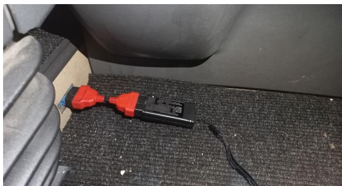
Слика 8.8 Постављање одговарајућег адаптера за повезивање са возилом преко OBD прикључка – пример возила врсте M3 када је OBD прикључак смештен испод седишта возача
