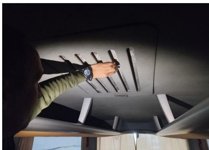
Слика 16.48 Провера причвршћености поклопца за приступ отвору у случају опасности
