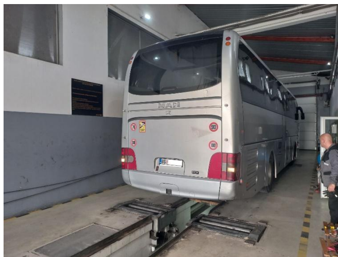
Слика 10.1 Провера функционалности уређаја кратким кретањем возила уназад – пример возила врсте M3, при чему се истовремено проверава функционалност уређаја за звучну сигнализацију кретања уназад (уколико такав уређај мора бити уграђен)
