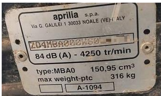
Слика 1.29 Приказ могућег изгледа произвођачке таблице возила врсте L3 (пример возила са слике 1.28)
