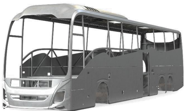
Слика 16.1 Каросерија аутобуса у виду решеткасте структуре са спољним оплатама
