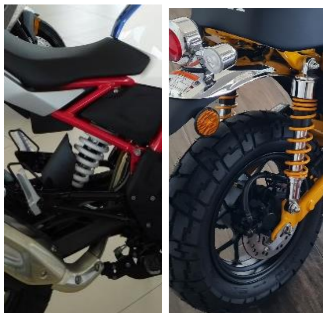
Слика 11.2 Приказ задњег ослањања возила врсте L3
