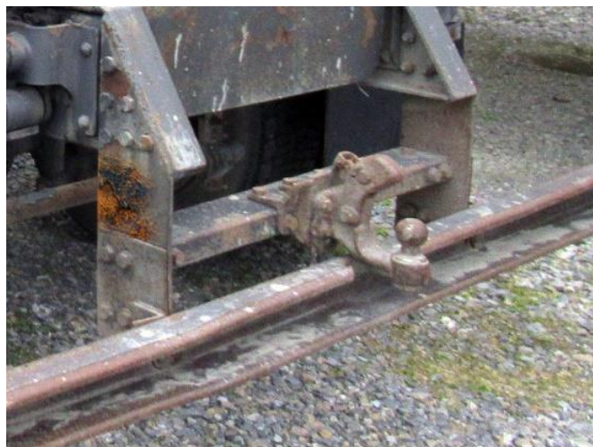
Слика 9.12 Дубинска корозија носача уређаја
