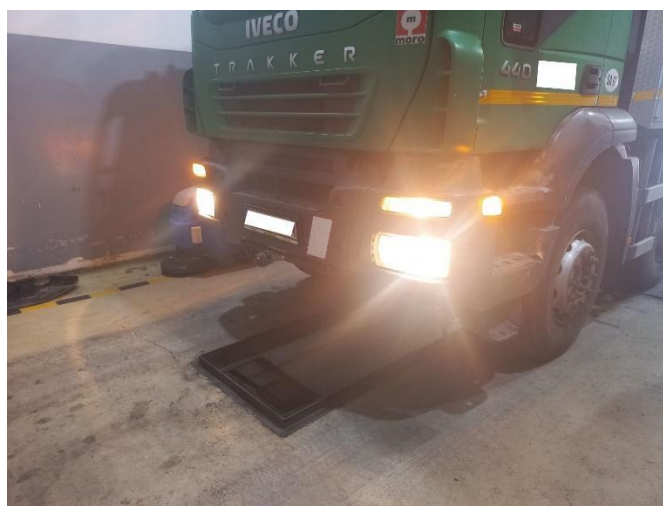
Слика 4.4 Провера функционалности кратких и дугих светала са истовремено укљученим осталим светлосним и светлосно-сигналним уређајима
