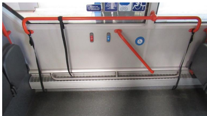
Слика 16.50 Провера постојања држача за инвалидска колица
