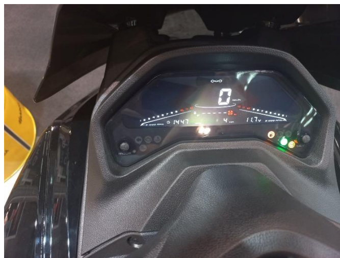
Слика 7.1 Провера осветљености контролне табле и постојања брзиномера са одометром – пример дигиталног брзиномера на возилу врсте L3
