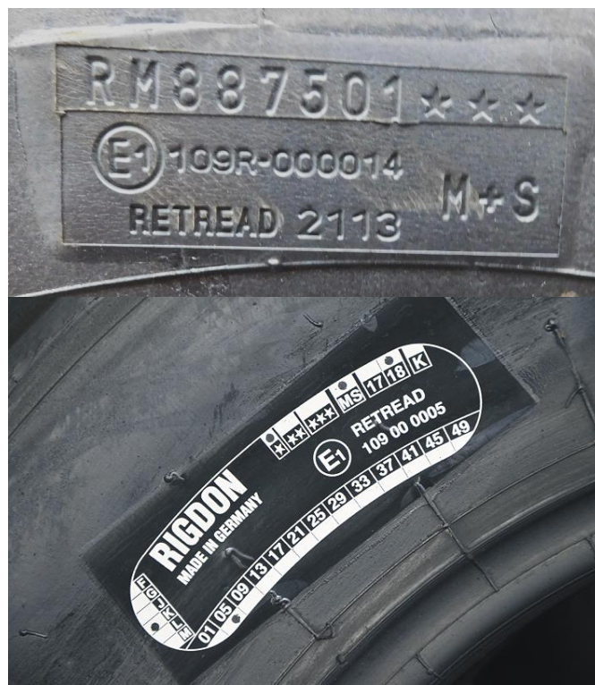
Слика 12.3 Приказ два различита начина означавања обновљених пнеуматика: утискивањем у бочницу (горе) и помоћу гумене етикете која се поставља на бочницу пре поступка вулканизације (доле)
