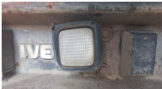
Слика 4.8 Пример фара за осветљавање места на коме се изводе радови уграђеног на задњем делу возила врсте N3 (на заштитнику од подлетања са задње стране)
