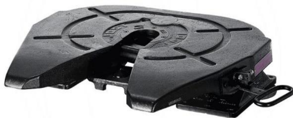
Слика 9.2 Седло класе G – уређај са аутоматским забрављивањем, спаја се са вучним „трном“ пречника 50 mm
