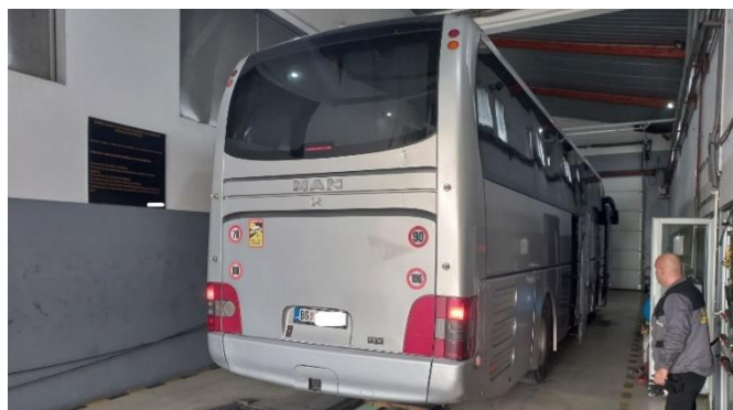
Слика 4.15 Провера функционалности стоп светала на примеру возила врсте M3
