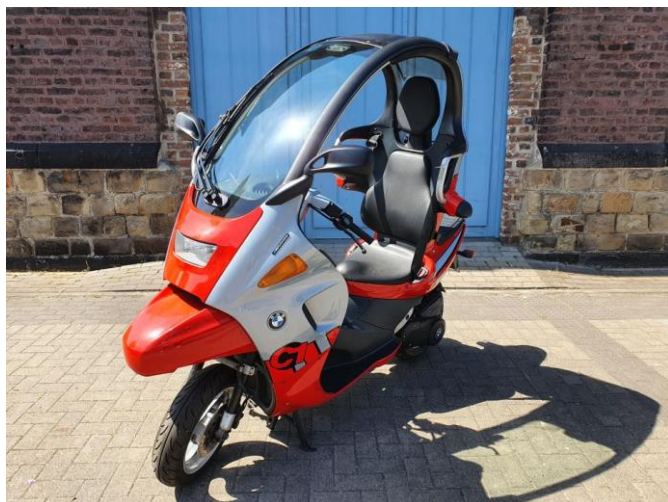
Слика 5.1в Ветробран на возилу врсте L1/L3 са кабином
