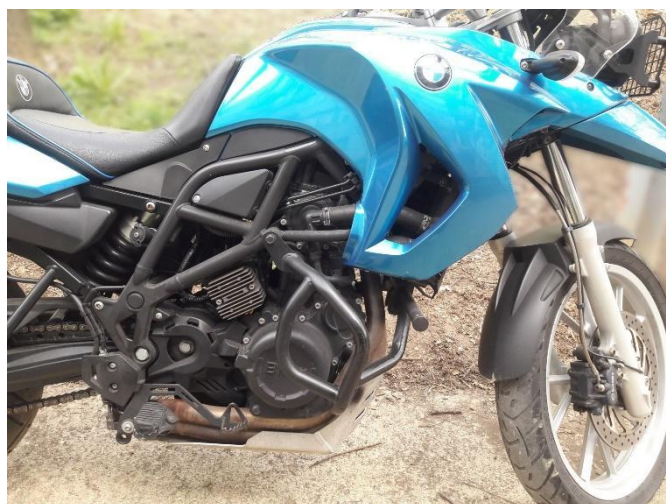
Слика 16.4 Провера визуелно доступних елемената шасије на возилу врсте L3
