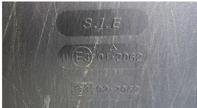
Слика 5.3 Хомологациона ознака возачког огледала класе II за возила врста M2, M3, N2 и N3 (класа III није предвиђена за уградњу на ова возила)
