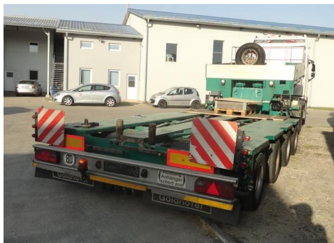
Слика 4.26 Пример означавања возила врсте О4 (50 модула на задњој страни)
