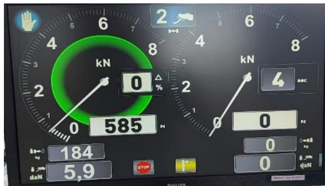
Слика 3.34 Мерење сила кочења, силе на команди и масе по точку на кочним ваљцима
