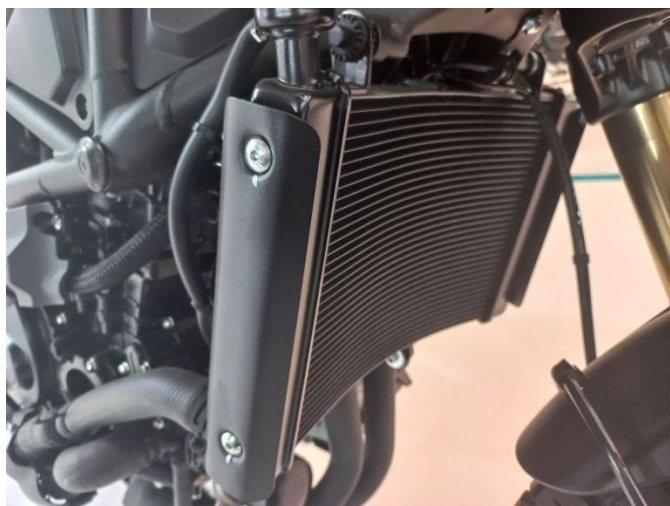
Слика 14.3 Визуелна провера постојања већих оштећења на хладњаку возила врсте L3 чији се погонски уређај хлади расхладном течношћу
