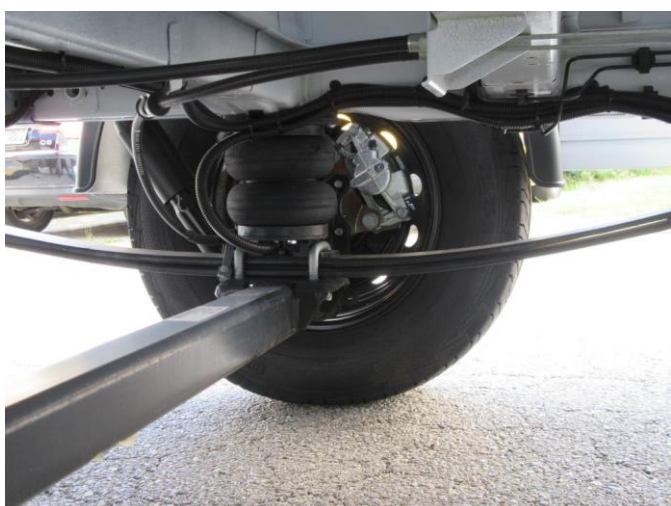
Слика 11.9 Пример накнадно уграђеног ваздушног јастука за повећање носивости возила
