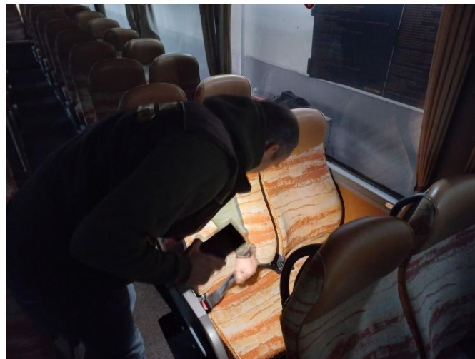
Слика 16.8 Провера функционалности сигурносних појасева и њихових прикључака на седиштима за путнике (по насумичном избору контролора) – пример возила врсте M3 класе III
