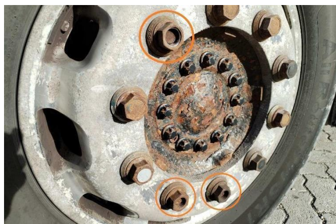
Слика 12.1 Неодговарајуће причвршћен наплатак
