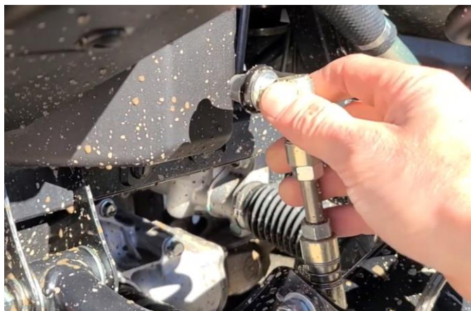
Слика 11.18 Провера споне на возилу категорије L7
