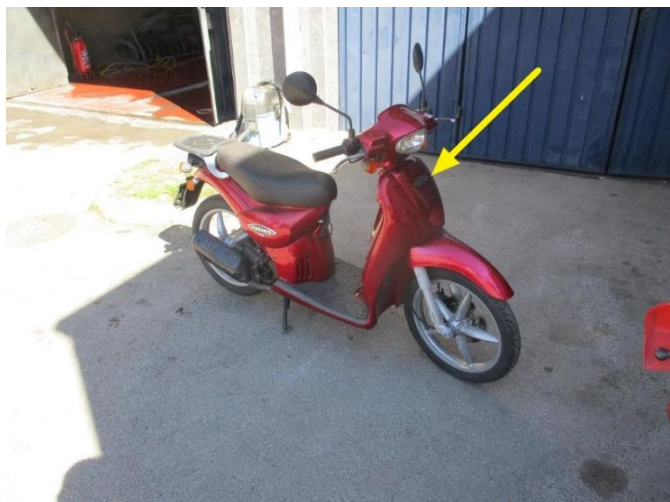
Слика 1.32 Приказ могуће позиције произвођачке таблице возила врсте L1
