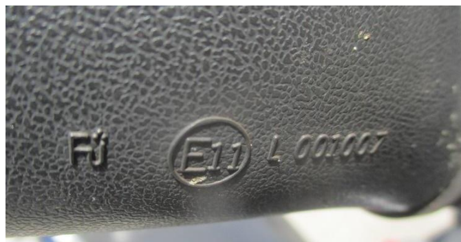
Слика 5.9 Хомологациона ознака возачког огледала
