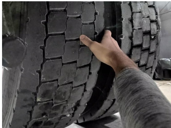
Слика 12.5 Приказ провере удвојених точкова
