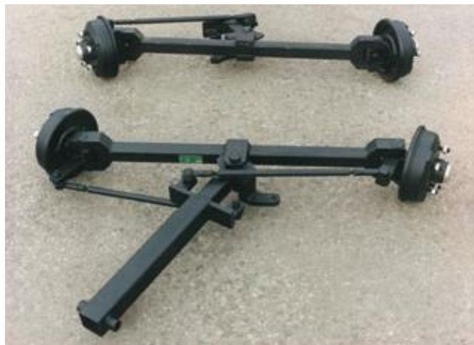
Слика 2.6 Приказ управљачког механизма прикључног возила са управљивим осовинама
