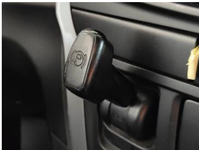
Слика 3.19 Команда подсистема за паркирно кочење
