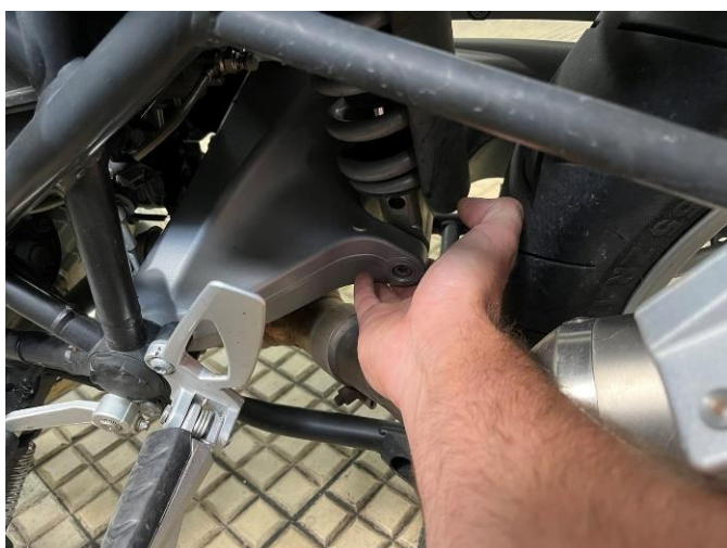
Слика 11.12 Провера елемената за вођење точка на возилу врсте L3
