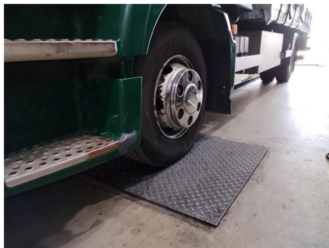
Слика 12.8 Провера зазора у зглобовима и лежајевима на развлачици
