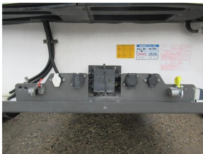
Слика 13.7 Електрични прикључци са одговарајућим поклопцима (возило врсте O4)
