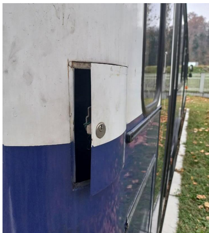
Слика 16.17 Поклопац на аутобусу који се без битних расклапања не може затворити на исправан начин
