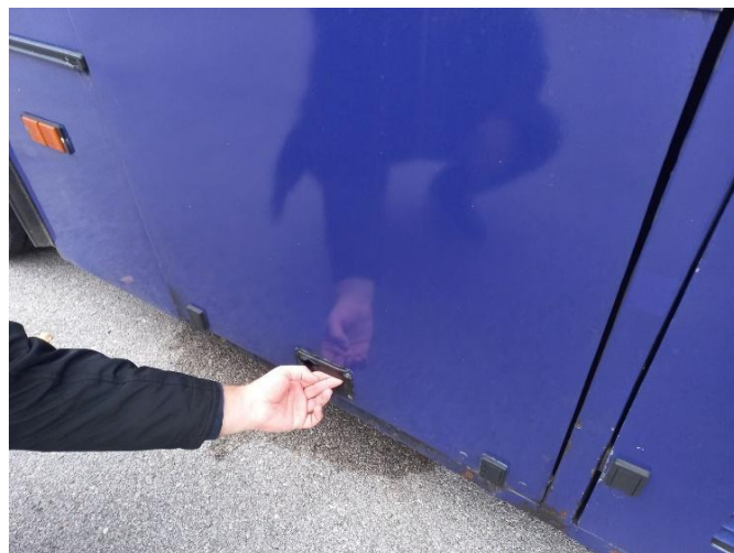
Слика 16.15 Провера причвршћености поклопца у затвореном положају
