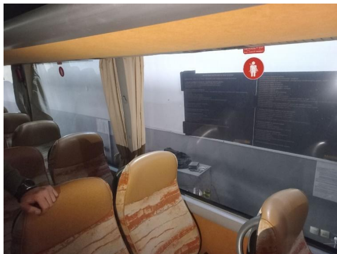
Слика 16.42 Пример прозора на левој бочној страни возила врсте М3 који служи као излаз у случају опасности
